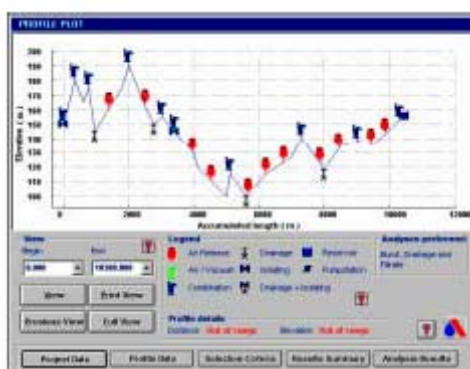
Figura 5.32. Perfil de la instalación
