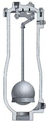
Figura 2.11. Ventosa para aguas residuales de ARI
