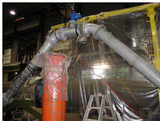
Figura 3.18. Montaje de la ventosa en el punto más elevado de la conducción
