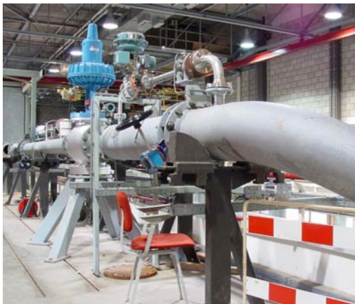
Figura 3.15. Instalación para los ensayos en flujo permanente. Detalle del By-Pass
