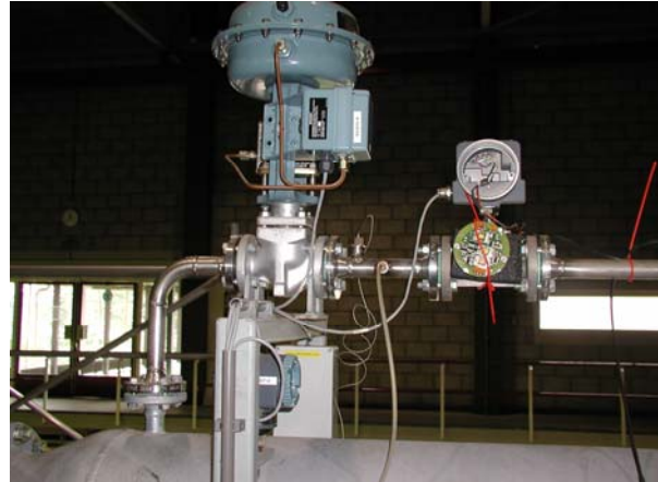
Figura 3.15. Instalación para los ensayos en flujo permanente. Detalle del By-Pass
