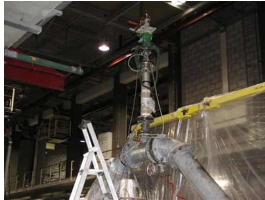
Figura 3.33. Ventosa sobre carrete vertical
