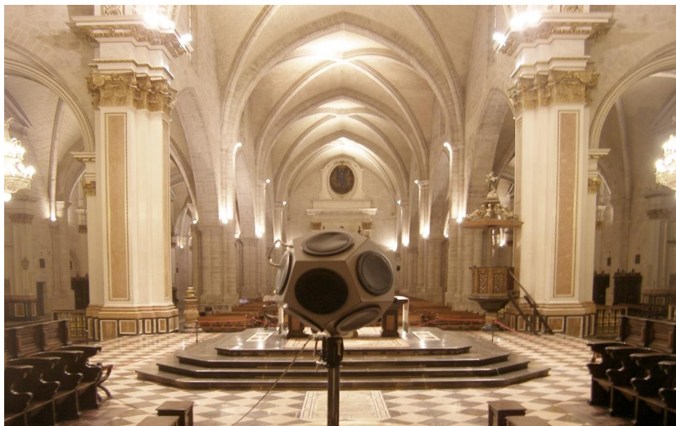
Figura 2.4. Medición acústica de la Catedral de Valencia realizada por el Grupo de Investigación en Acústica Virtual UPV-UVEG.
