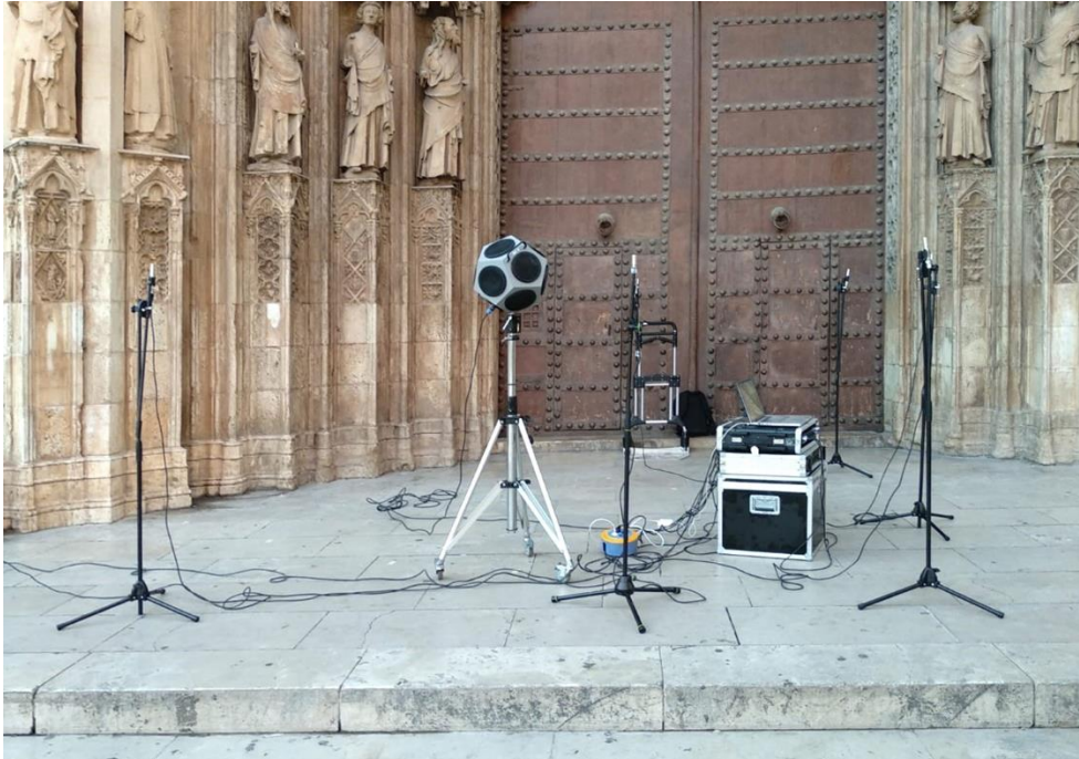
Figura 2.4. Medición acústica del Tribunal de las Aguas realizada por el Grupo de Investigación en Acústica Virtual UPV-UVEG.
