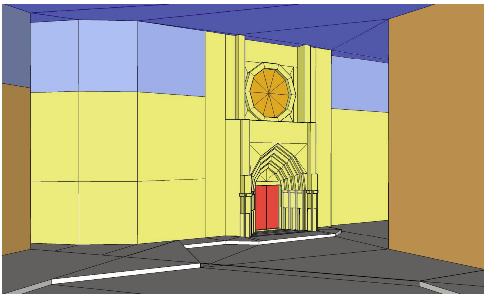
Figura 2.9. Modelo acústico del entorno del Tribunal de las Aguas con la distribución de capas. Vista detalle de la Puerta de los Apóstoles.
