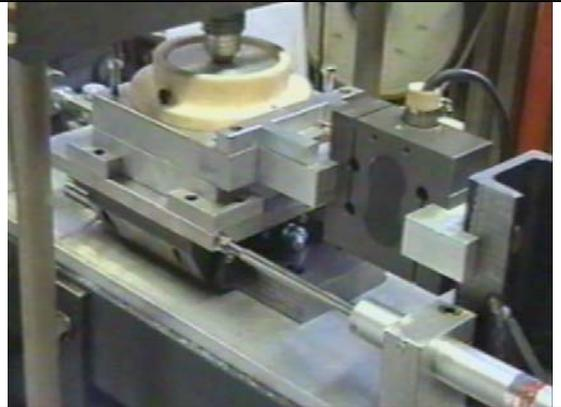
Foto 6: Sensor de desplazamiento horizontal
