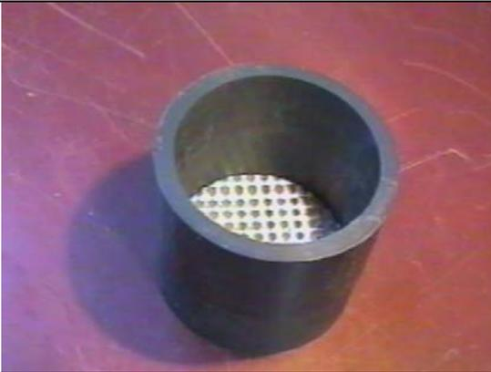
Foto 9: Cilindro de PVC con placa inferior
