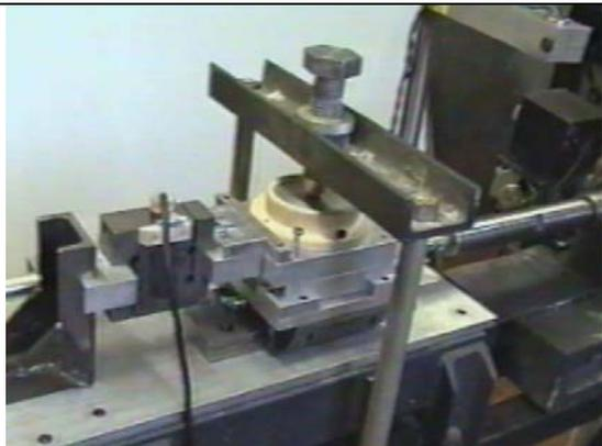
Foto 19: Probeta preparada para ser comprimida y cortada
