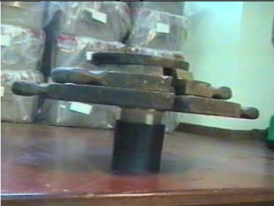
Foto 13: Aplicación de la tensión normal inicial de 50 kPa
