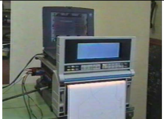
Foto 24: Registro y almacenamiento de los datos en Gould TA11 y ordenador portátil
