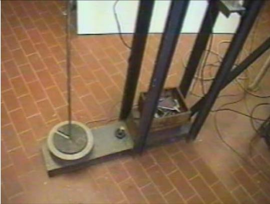
Foto 21: Extremo de la palanca para colocar los pesos
