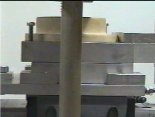
Foto 23: Corte de probeta (fin)
