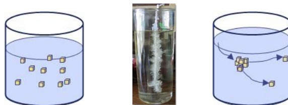
Figura 5. Representación de la nucleación primaria homogénea, en el seno de la disolución sobresaturada (izquierda); la nucleación primaria heterogénea, favorecida por la presencia de sólidos (un hilo en la fotografía del centro); y la nucleación secundaria por esfuerzo cortante (derecha)
