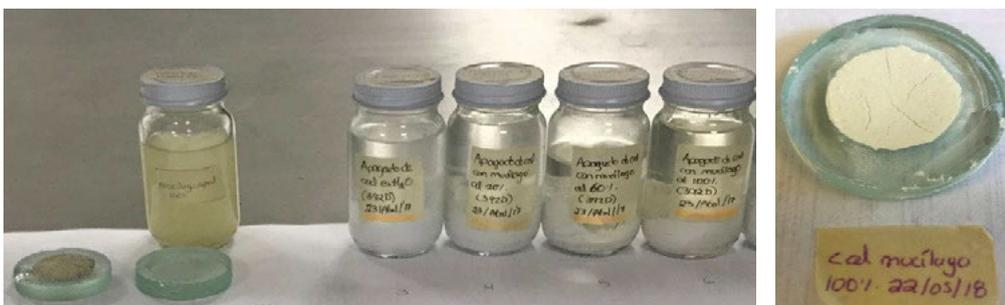
**Fig. 3** Proceso de preparación de probetas de pasta de cal hidratada en mucílago de nopal en concentraciones del 0% (en H<sub>2</sub>O)
