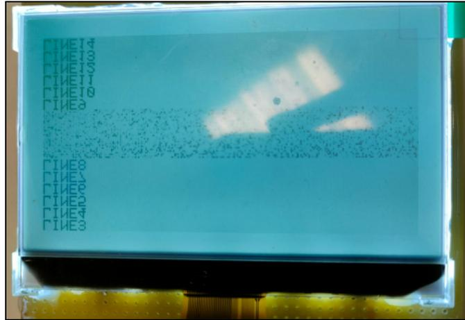
*Figura 96. Visualización por pantalla error.*
