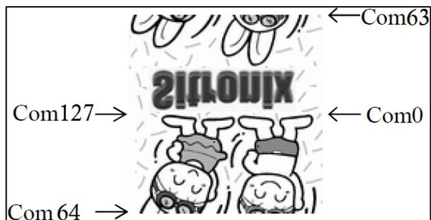
Figura 38. Dirección del escaneo común 4
