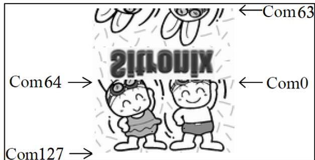
Figura 37. Dirección del escaneo común 3
