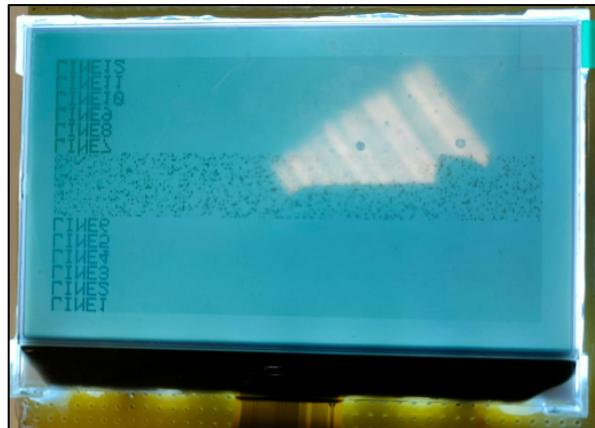
*Figura 97. Visualización por pantalla error.*
