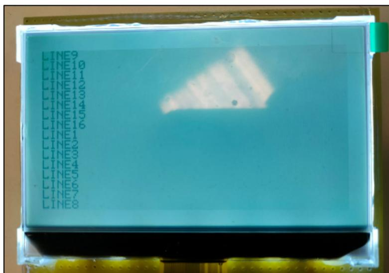
Figura 93. Visualización en la pantalla con configuraciones por defecto.
