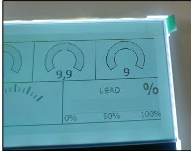
*Figura 138. Pruebas para encontrar la posición centrada de los valores en el gráfico en forma de arco.*
