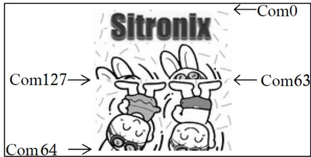
Figura 36. Dirección del escaneo común 1
