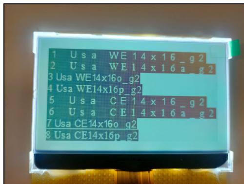
Figura 133. Error de visualización del tipo de letra por pantalla.
