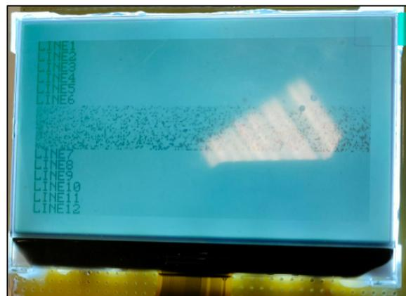
*Figura 98. Visualización por pantalla error.*
