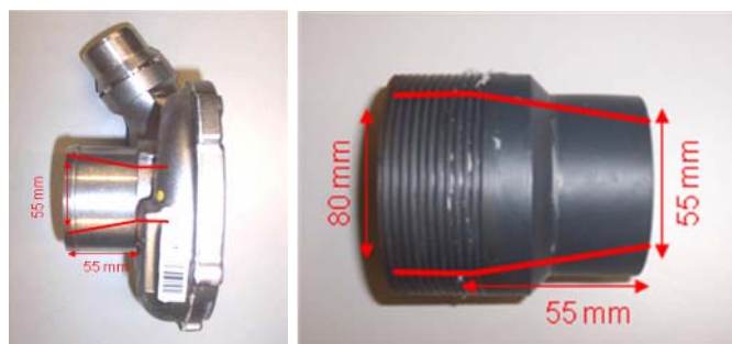
Figura 5.12 Entrada del compresor con cono interior (izquierda) y extensión (derecha)
