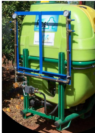
Figura 20. Montaje del sistema hidráulico y electrónico sobre un pulverizador hidráulico suspendido.
