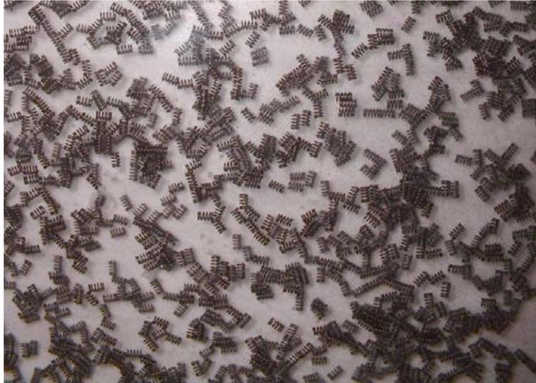
**Fig. 2.50.** Material quiral construido con hélices.
