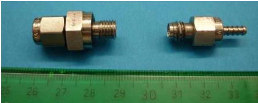
Figure 2.5.6: Components of a co-field treatment chamber. ). Instituto de Agroquímica y Tecnología de Alimentos, Valencia, (Spain).
