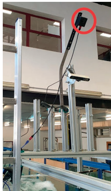
Figura 3 | Cámara de tiempo de vuelo instalada en el canal para la toma de datos.
