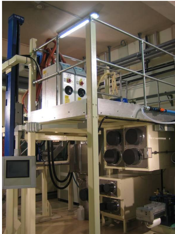
Figura 2.4.- Planta piloto de extrusión de fibras termoplásticas de AITEX.
