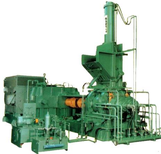
Figura 1-3. Mezclador intensivo de dos tornillos sinfín tipo Banbery.
