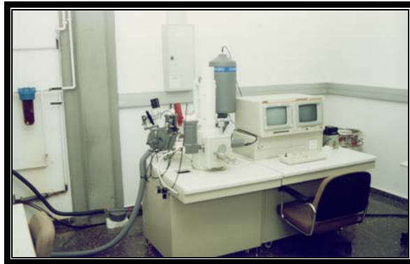
Figura 4.2. Cryo-Trans CT1x500C de Oxford Instruments acoplado a un microscopio electrónico de
