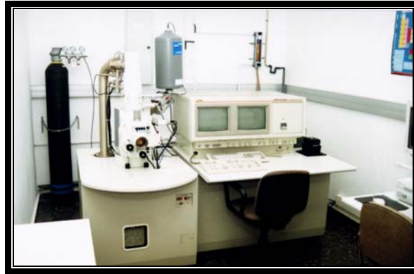
Figura 4.5. Microscopio electrónico de barrido JEOL 6300.
