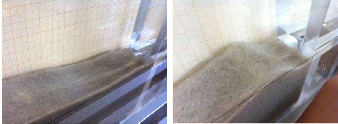
Figura 4.9. Dos fosas completamente separadas (izquierda) y fosa prácticamente unificada (izquierda) aguas abajo de la zona protegida
