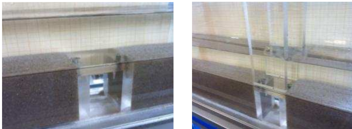
Figura 4.3. Plataforma de metacrilato que representa la protección del lecho del cauce (izquierda) y placas y plataforma montadas en el canal sedimentológico (derecha)
