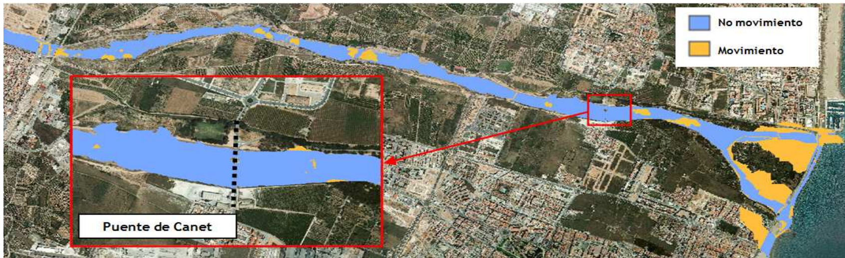
Figura 5.10. Mapa de movimiento - no movimiento del material del lecho en el tramo de estudio. Detalle del entorno del puente de Canet (no se observa movimiento)
