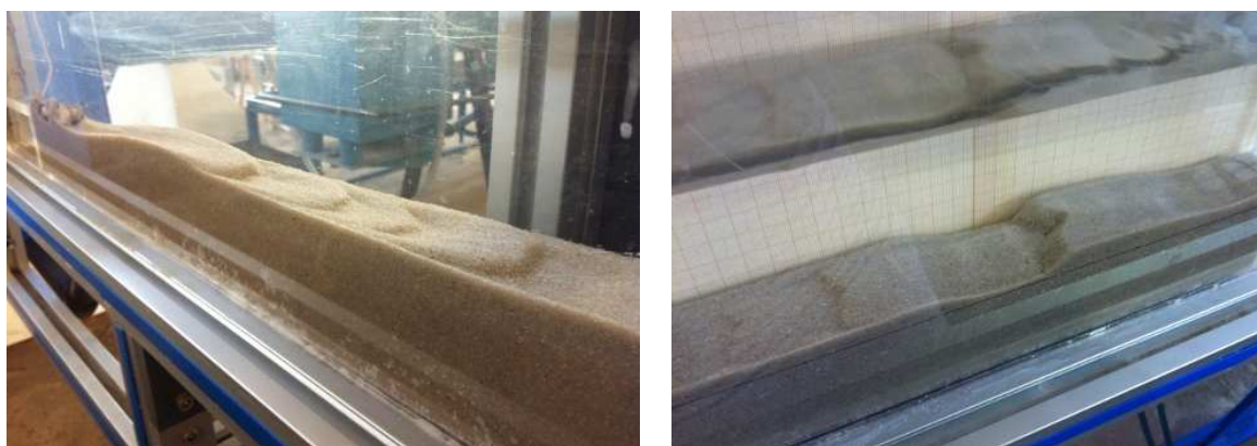
Figura 4.18. Formación de dunas en el tramo de aproximación (izquierda) y aguas abajo de la cuña de deposición (derecha)
