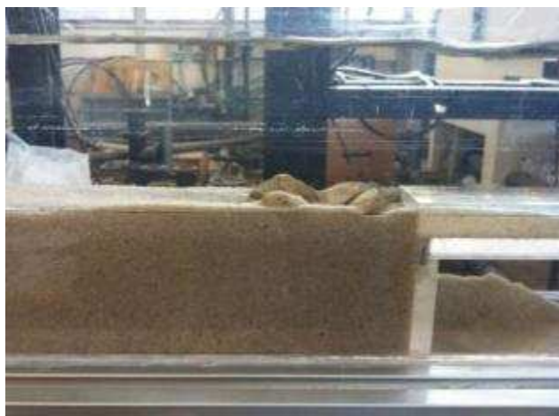
Figura 4.2. Zona de transición en la entrada (izquierda) y vertedero en el extremo aguas abajo del canal sedimentológico (derecha)
