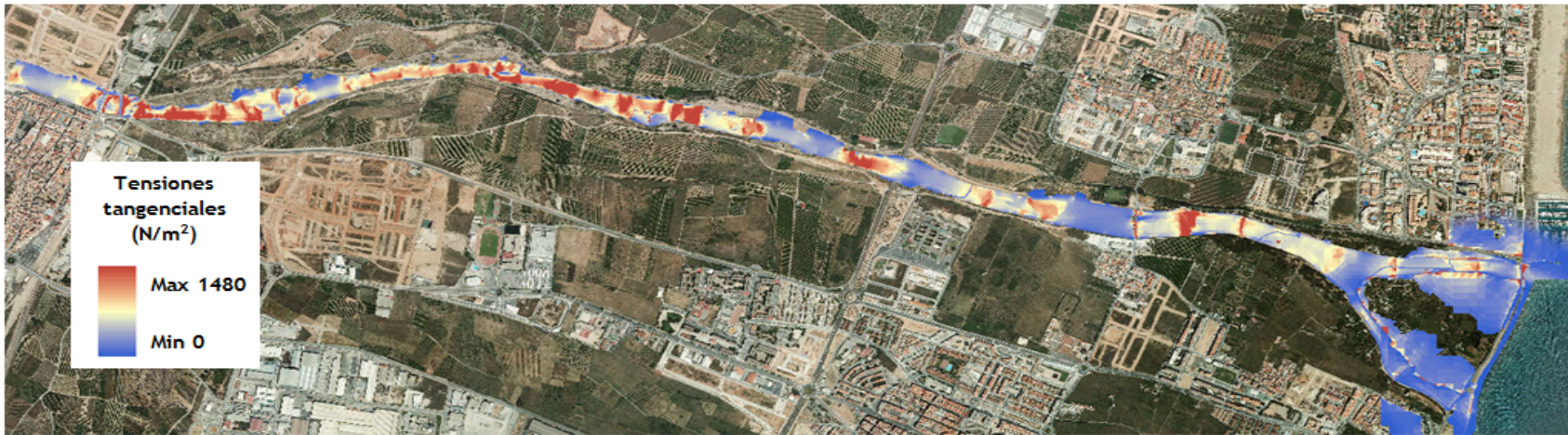
Figura 5.9. Mapa de tensiones tangenciales desarrolladas sobre el material del lecho
