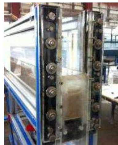
Figura 4.2. Zona de transición en la entrada (izquierda) y vertedero en el extremo aguas abajo del canal sedimentológico (derecha)
