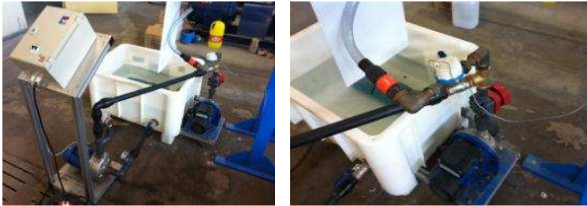
Figura 4.5. Bombas de alimentación del circuito hidráulico del canal sedimentológico (izda.) y contador situado inmediatamente aguas abajo de la conexión (dcha.)
