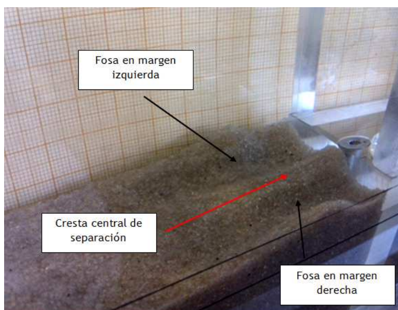
Figura 4.22. Fosas de socavación aguas abajo separadas por una cresta de arena
