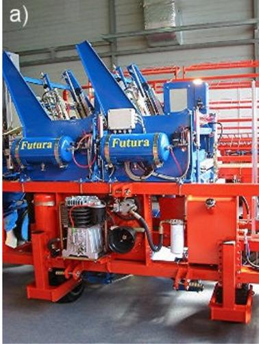
Fig. 2.17 a) Vista frente trasplantadora FUTURA totalmente automática.
