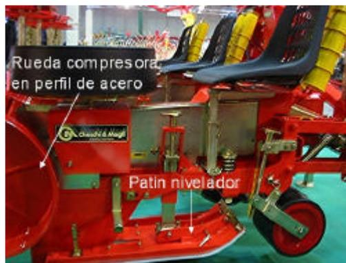
Fig. 2.14 Trasplantadora con "patín nivelador y prensor" de suelo antes y durante la labor de la reja abre-surco, inmediatamente después, la rueda compactadora logra un óptimo trabajo.
