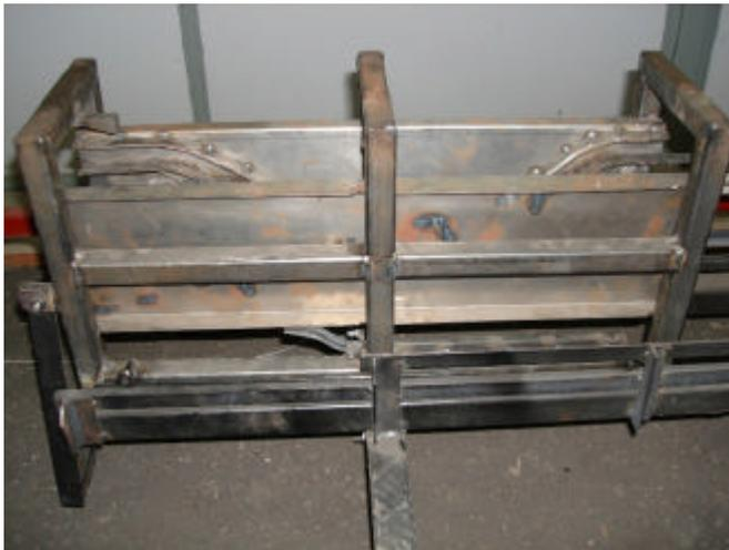
Fig. 6.11 Soporte de guías del dispositivo de pruebas
