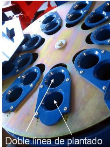
Fig. 2.16. b) arreglo para alimentar dos líneas de plantado (Ferrari Costruzione).
