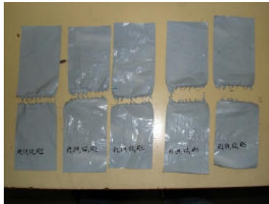
Fig. 5.16 Probetas de plástico después de cortadas Combinación P1C4V1
