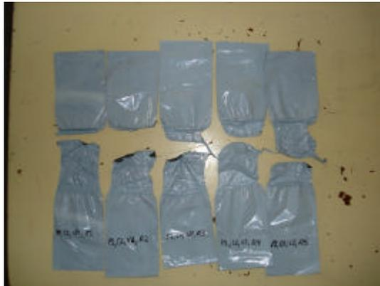
Fig. 5.15 Probetas de plástico después de cortadas Combinación P2C2V2
