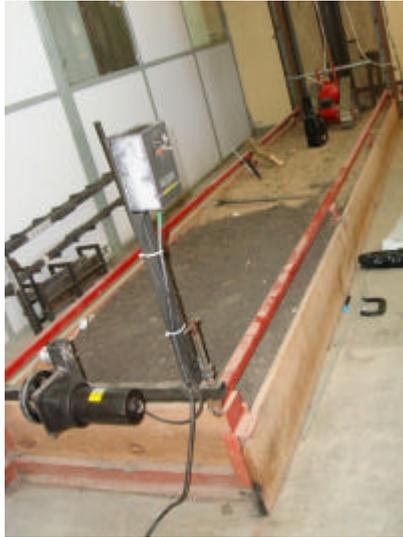
Fig. 6.12 Sistema de tracción del dispositivo de pruebas
