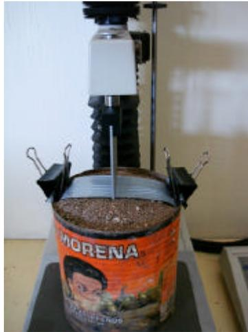
Fig. 5.8 Probeta de suelo y plástico a ser ensayados
