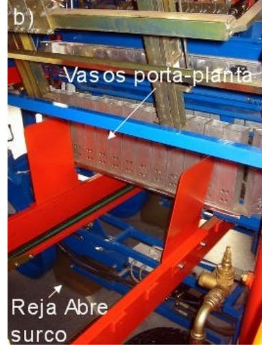
Fig. 2.17 b) Cinta con vasos verticales que giran en plano horizontal.
