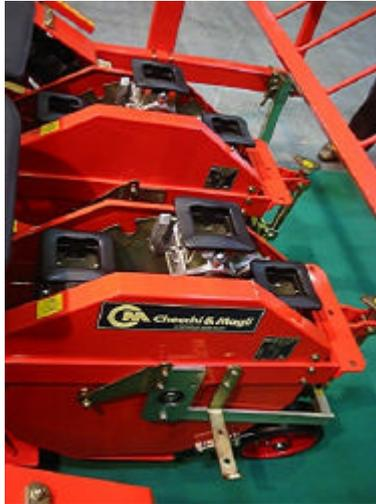
Fig. 1.11 Trasplantadora de cepellones para suelos acolchados
