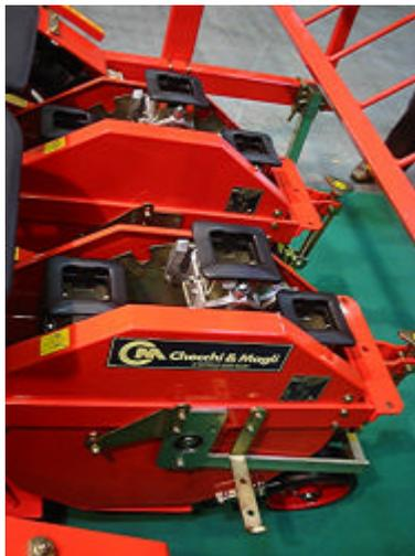
Fig. 2.8 c) cuerpo distribuidor de trasplantadora (checcchi & magli).
