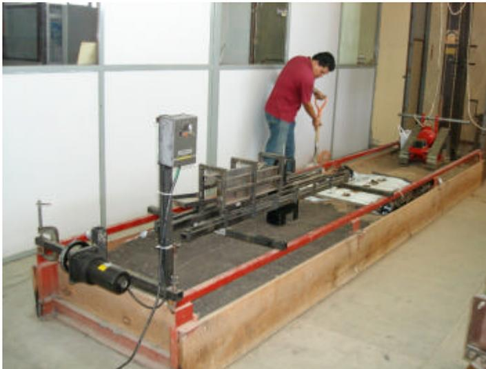
Fig. 6.9 Tanque de suelo (soil bin)
