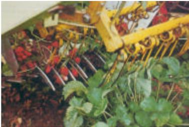
Fig. 1.6 Cosechadora de fresa.
