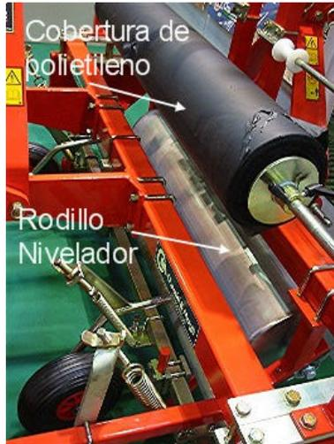
Fig. 2.18 a) soporte para cobertura de polietileno y rodillo nivelador.
