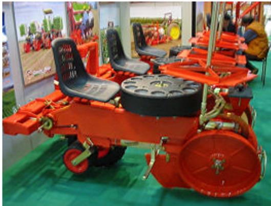
Fig. 2.7 c) trasplantadora en base a este principio (chechi & magli).
