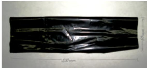
Fig. 5.2 Probeta de plástico
