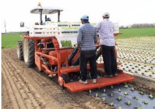
Fig. 2.19 Trasplantadora para cepellones en suelos acolchados
