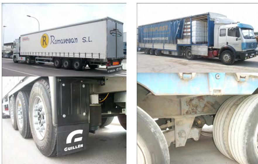
Figura 5.4. Izq.: Trailer con suspensión neumática. Der.: Trailer con suspensión mecánica
