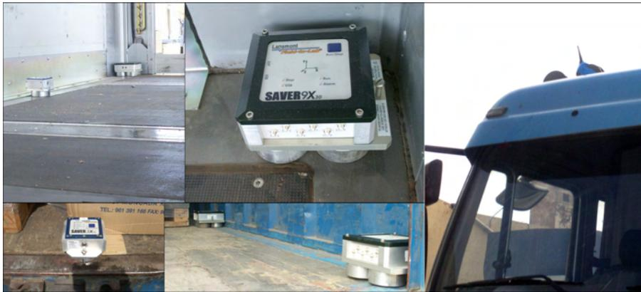
Figura 5.5. Instalación de los registradores de vibraciones y del GPS+GSM
