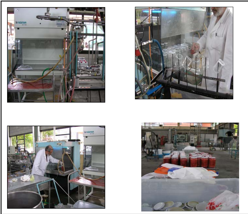
Figura III. 5. Envasado en cámara de flujo laminar y esterilización de los frascos
