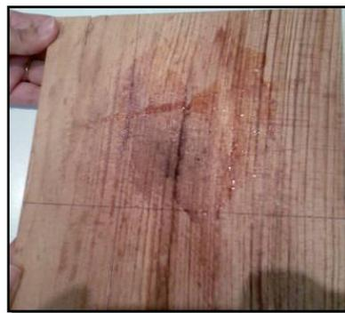
Figura 4-50. Efecto de un tratamiento excesivo sobre la madera
