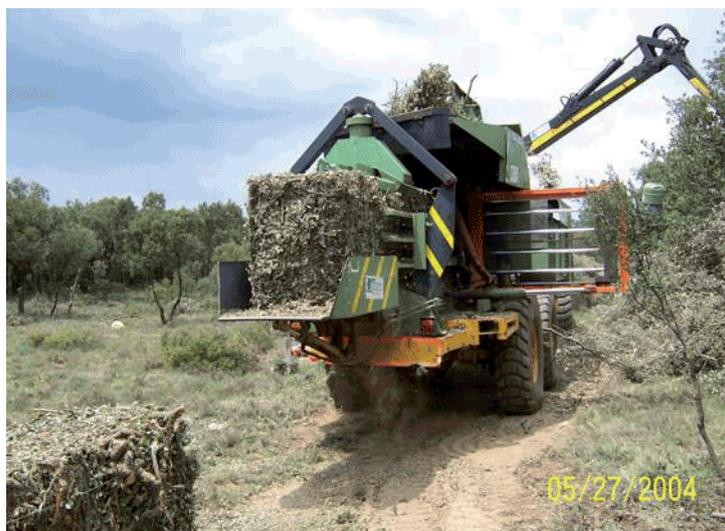
Figura 3-13. Máquina empacadora de biomasa (cortesía de TRABISA, S.L.)
