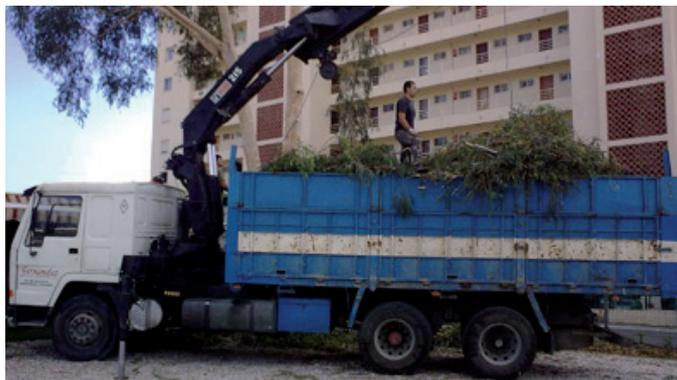
Figura 3-12. Camión de carga de biomasa a granel (sin empaclar)
