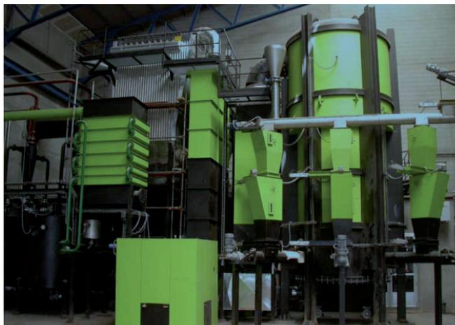
Figura 3-30. Planta de gasificación de lecho fluido burbujeante. Módulo de 1000 kg/h. (MOVIALSA, Fuente IDAE)
