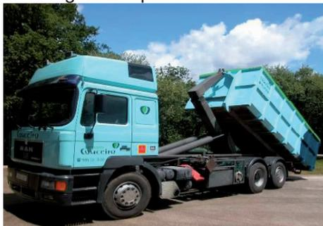
a) Camión MAN para transporte y volcado de astillas con remolque (capacidad total 120 -140 m<sup>3</sup>).
