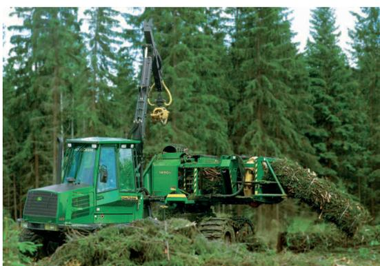
Figura 2-10 Empacadora modelo "FiberPack" de la marca John Deere
