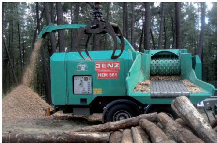
Figura 2-8 Astilladora semimóvil con motor diesel
