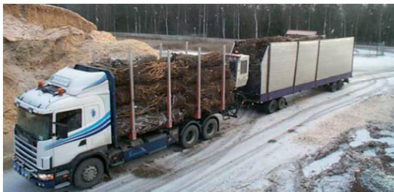
Figura 2-11 Camión con remolque y grúa para transporte de pacas.
