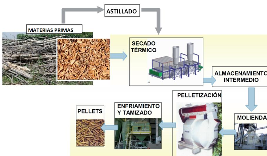
Figura 3-26. Esquema planta de pellets
