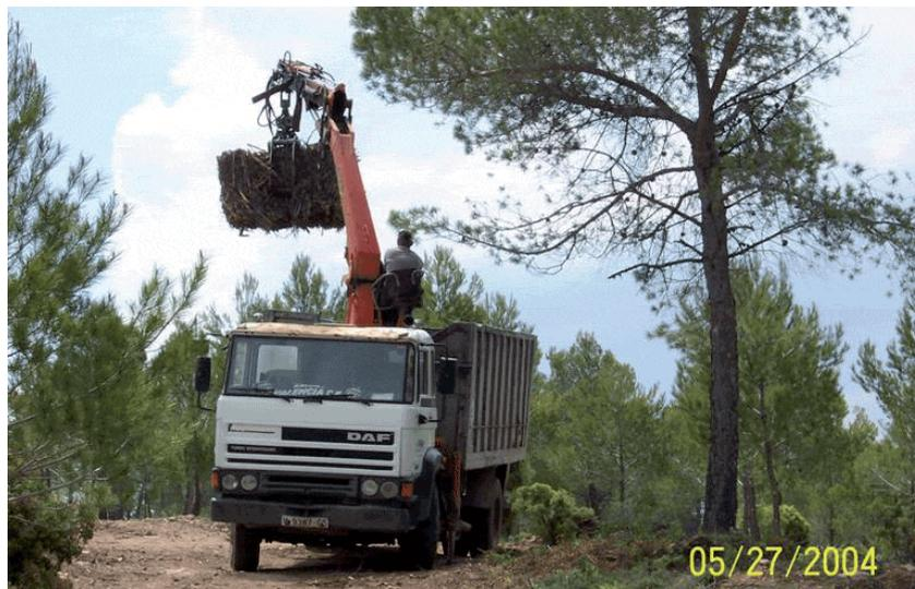
Figura 3-14. Carga de las pacas en camión convencional con grúa (cortesía de TRABISA, S.L.)
