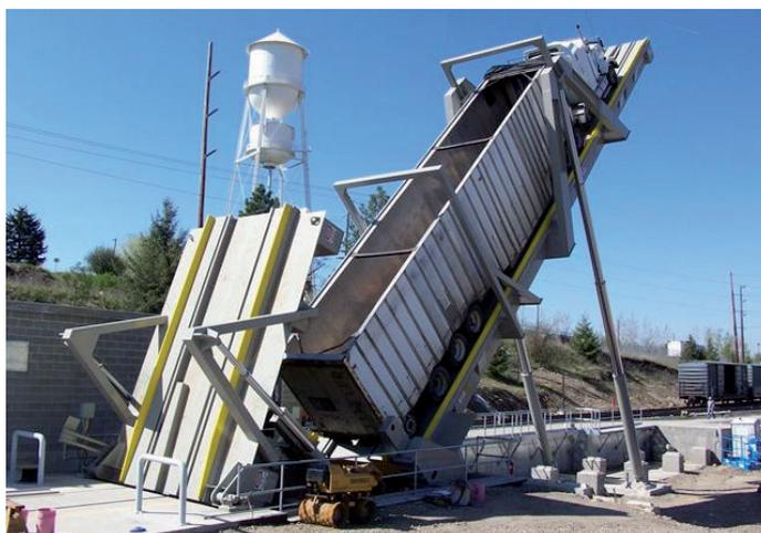
Figura 3-25. Volteador de camiones o "truck tipper"
