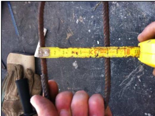
Fotografía 11.- Medición de las arm.transversales
