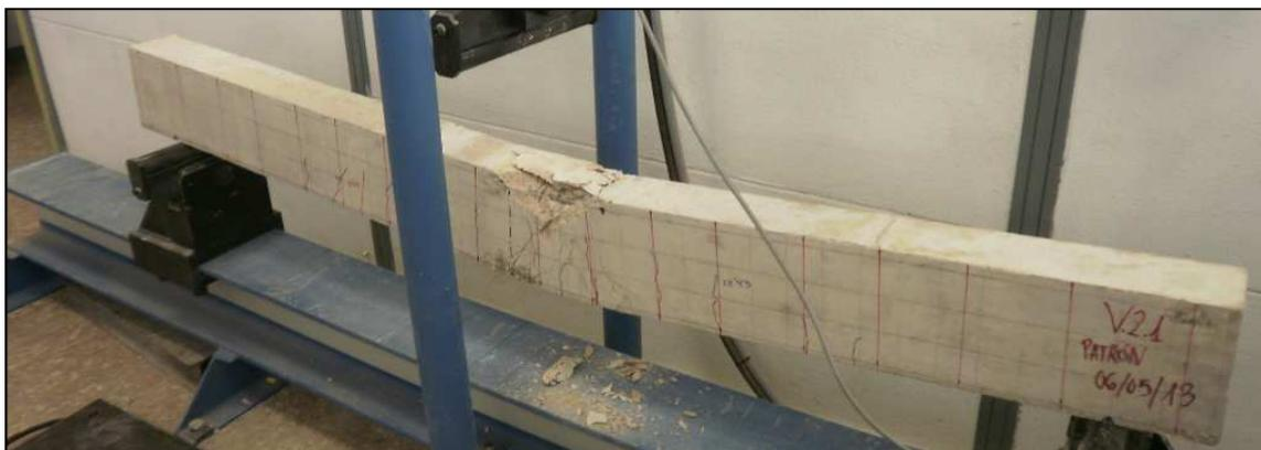
Fotografía 81.- Rotura viga
