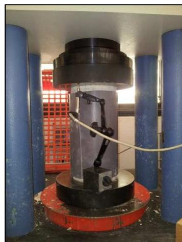
Fotografía 80.- Ensayo de rotura o deformación total
