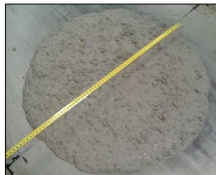
Fotografías 20 y 21.- Realización del ensayo de escurrimiento sin fibras
