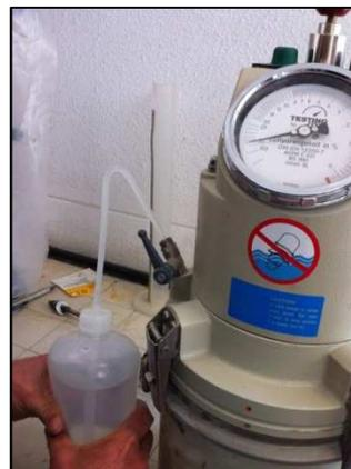
Fotografías 30 y 31.- Realización del ensayo del aire ocluido
