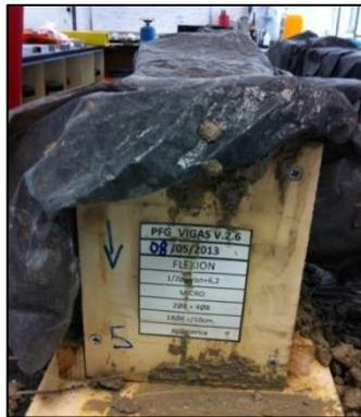
Fotografía 35.- Recubrimiento con plástico de la viga una vez hormigonada
