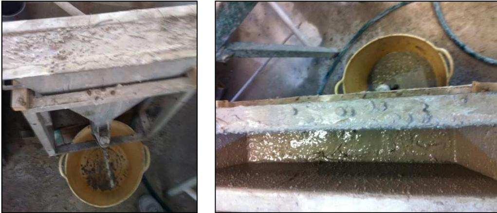
Fotografías 28 y 29.- Realización del ensayo del embudo en “V”
