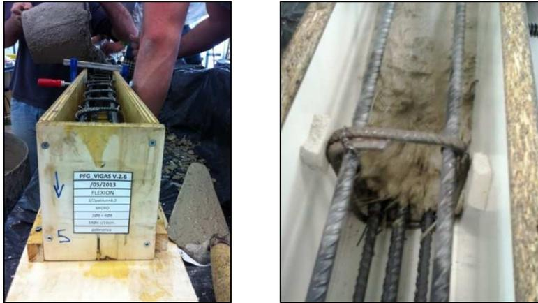
Fotografías 33 y 34.- Hormigonado de la viga
