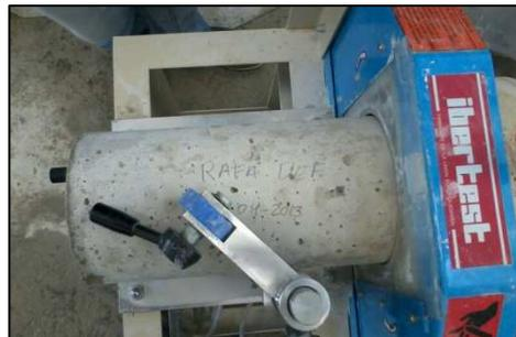
Fotografía 49, 50 y 51.- Refrentado probetas cilíndricas
