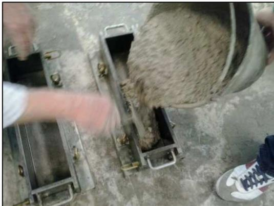
Fotografía 37.- Hormigonado de las probetas
