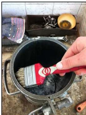
Previo al hormigonado las probetas deben estar limpias de restos de hormigón de ensayos anteriores. Para facilitar el proceso de desencofrado se debe aplicar por el interior, un producto desencofrante tanto en su base como en las paredes del recipiente. Para ello nosotros hemos utilizado como producto desencofrante aceite vegetal.
