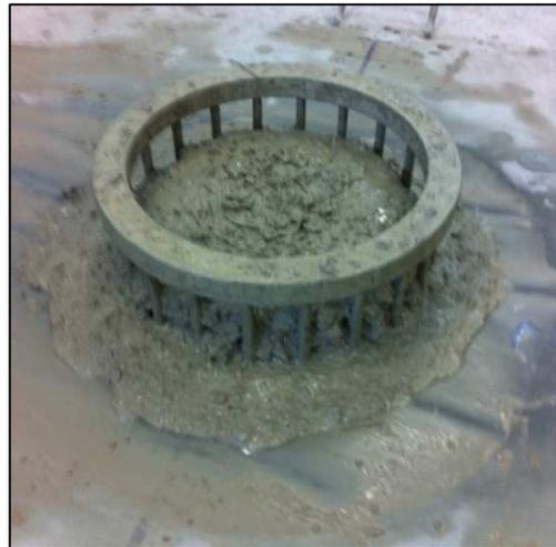
Fotografía 26.- Rellenado del cono del anillo Japonés      Fotografía 27.- Extensión de la mezcla
