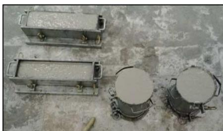
Fotografía 38.- Probetas hormigonadas
