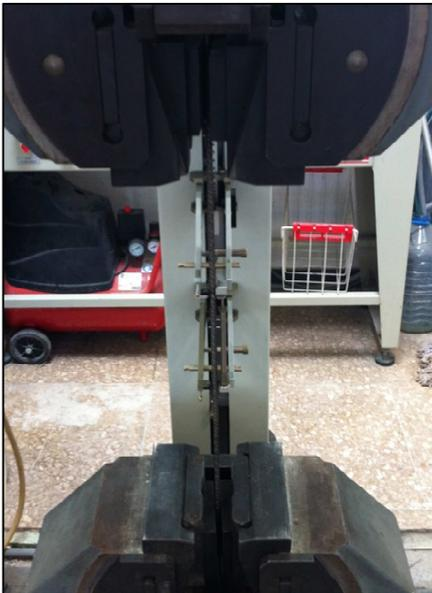
Fotografía 58.- Realización de ensayo de tracción
