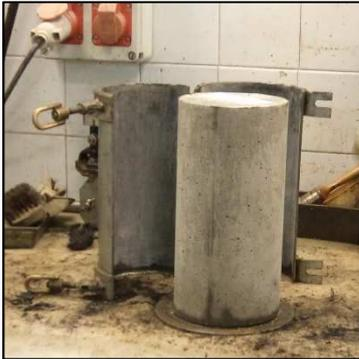
Para desmoldar las probetas, se debe desenroscar las tuercas de apertura de las probetas y con una maza impactar por el exterior con una maza para facilitar que se desmolde bien la probeta. Una vez realizado este proceso abrimos el molde y se retira. Para despegar la base con darle con la maza en el borde del mismo contra el acero basta, a continuación codificamos las probetas y las insertamos en la camada de curado.
