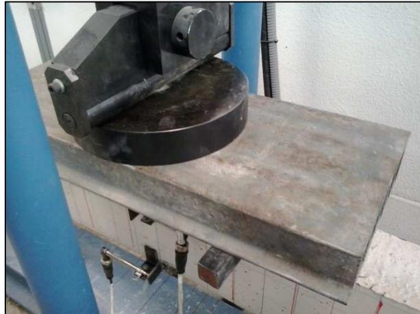
Fotografía 62.- Colocación de la tabla para mejor reparto de cargas.
