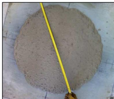
Fotografía 1.- Ensayo de escurrimiento.
