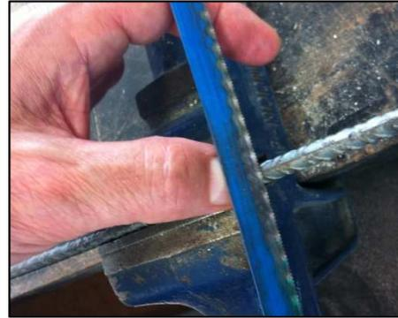
Fotografía 56 y 57.- Realización marcas para medir tras el ensayo de tracción
