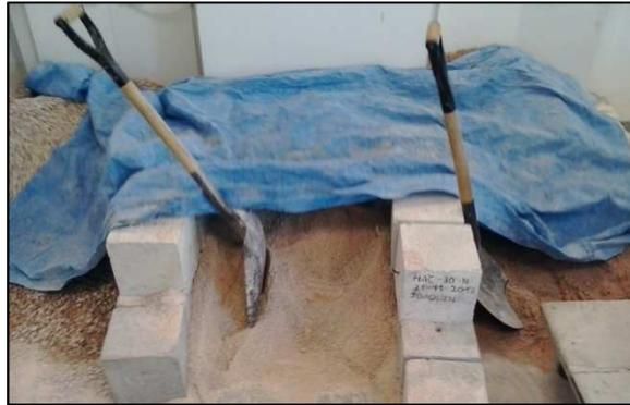
Fotografía 5.- Zona de acopio del árido del laboratorio de materiales. De izda. a dcha. Grava, arena 0/2 y arena 0/4mm respectivamente.
