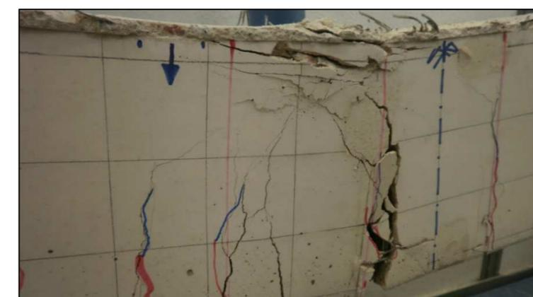
Fotografía Viga patrón + 12,4 Kg/m<sup>3</sup> V\_2\_4
