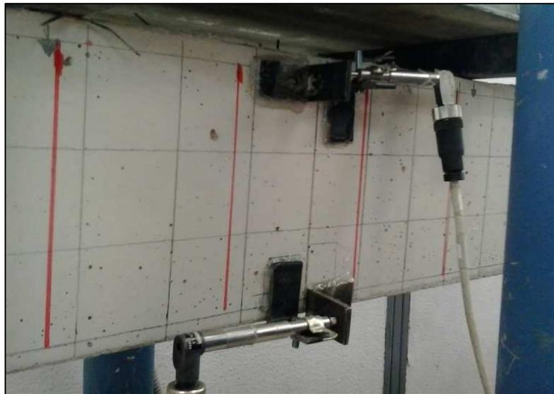
Fotografía 61.- Viga preparada para ensayar a flexión con captadores colocados
