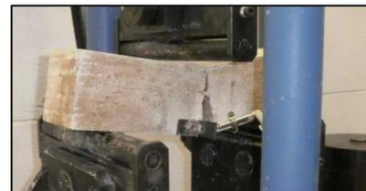
Fotografía 64.- Rotura probeta
