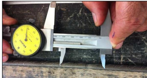
Fotografía 59.- Medición de  $\Delta$  de alargamiento en rotura
