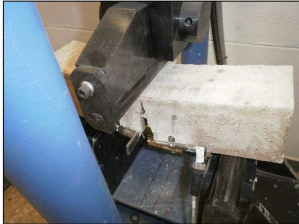
Fotografía 46.- Rotura probeta prismática de hormigón
