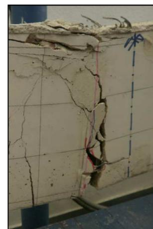
Fotografías 86 y 87.- Rotura viga
