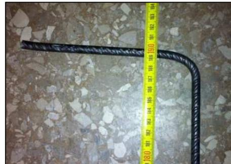
Fotografía 12.- Medición de las arm. longitudinales
