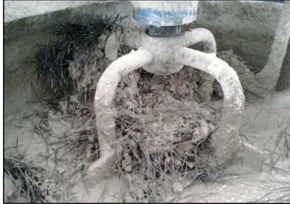
Fotografía 22.- Reamasado de la mezcla de hormigón con fibras
