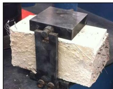
Fotografías 47 y 48.- Colocación ½ probeta prismática
