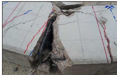
Fotografías 88, 89 y 90.- Rotura viga
