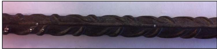
Fotografía 54.- Barra de  $\varnothing$  8 mm
