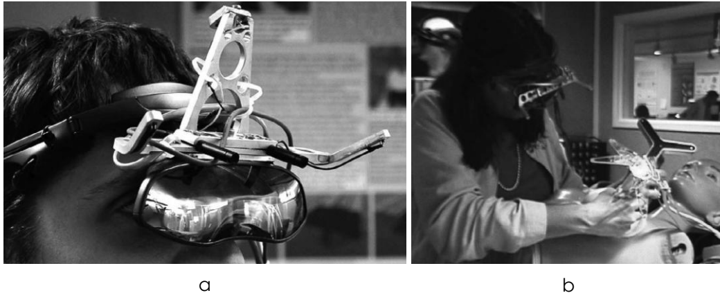
Figura 74. Registro óptico-electrónico: a) HMD con dos videocámaras en miniatura y tres LEDs de infrarrojos; b) Mujer realizando una simulación de una biopsia con el sistema descrito. En (Rosenthal et al., 2002).
