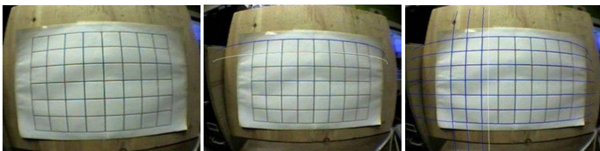
Figura 128. Patrón de calib_cparam y dos ejemplos de calibración de la cámara. En (Kato et al., 2000a, 28).
