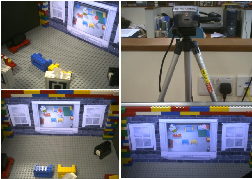
Figura 245. Algunas mejoras añadidas: TV sobre fondo de pared; posición de la cámara más elevada para aumentar la zona visualizada y evitar oclusiones.
