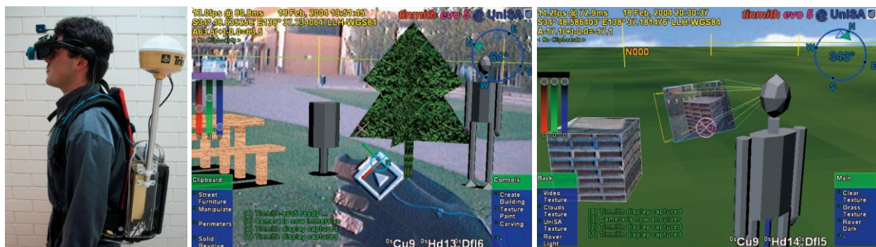
Figura 87. Aplicación de RA en la que el usuario lleva GPS y un sensor inercial para el registro de su posición y orientación, y marcas para el reconocimiento de gestos de las manos. En (Piekarski, 2006).
