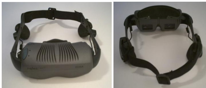
Figura 98. HMD de vídeo utilizado en los ensayos de esta tesis: i-glasses PC/SVGA .
