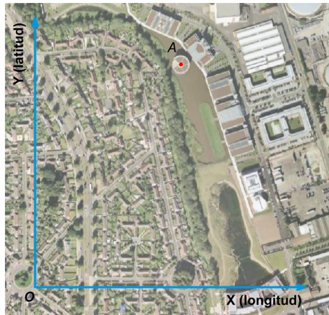
Figura 222. Sistema de referencia terrestre local, donde O es el origen de coordenadas (0, 0) y A representa un punto cualquiera con coordenadas ( X_A , Y_A ).
