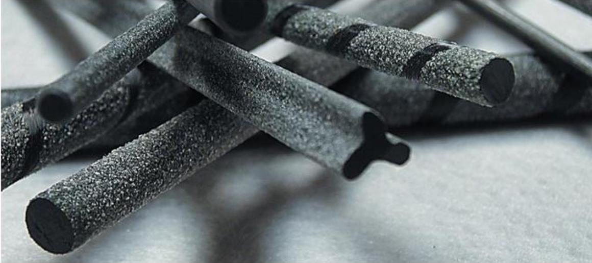
CARBOPREE® es una nueva línea de productos compuesta por barras y perfiles realizados con fibras de carbono impregnadas con resina vinil éster y superficie recubierta con arena de cuarzo.
