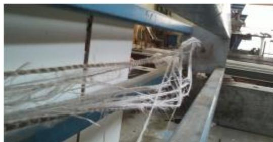
Figura 5.5 Rotura de la barra de GFRP (Benavent Serra 2012)
