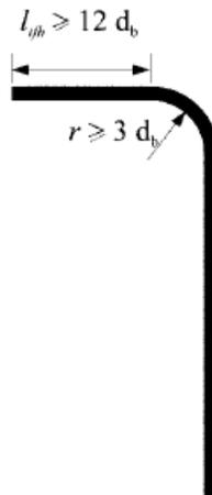
Figura 4.16 Radio mínimo y longitud de la patilla.
