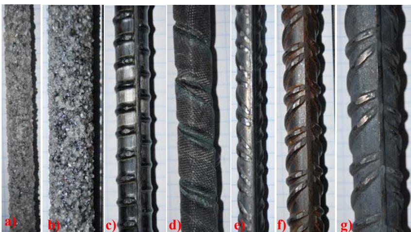
**Fig. 3.46** Barras de CFRP: a) arenada “CA8”; b) arenada “CA14”; c) Corrugada “CC12”; d) Texturizada “CT13”; y de acero: e) Corrugada “A8”; f) Corrugada “A12”; g) Corrugada “A16”.
