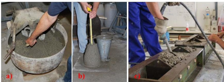
**Fig. 3.54.** a) Fabricación de hormigón; b) Ensayo de consistencia; c) Vertido y compactado de hormigón.
