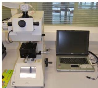
**Fig. 3.76.** Máquina de ensayo de microdureza. Microdurómetro Shimadzu modelo HMV-2.
