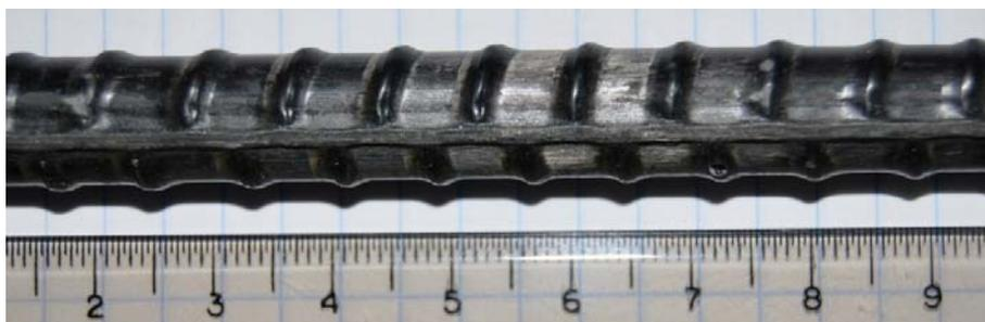
**Fig. 3.30.** Geometría superficial de las barras de CFRP corrugadas CC12.
