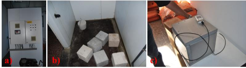
Fig. 3.7. a) Cámara; b) Ciclo de 5 °C; c) Probeta de hormigón en caja térmica con sonda.
