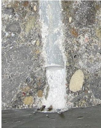
**Fig. 2.57.** Estado de la barra de FRP arenada tras el ensayo de pullout. Davalos et al., 2008.
