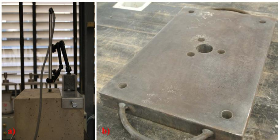
**Fig. 3.49.** a) Placa de sujeción captador extremo no tensionado; b) Placa de sujeción de probetas de pullout.
