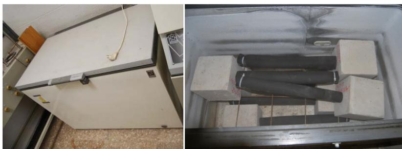
Fig. 3.51. Arcón frigorífico para condición climática de Hielo/Deshielo a -20 °C.
