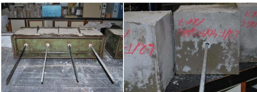
**Fig. 3.55.** Desmoldado y marcado de las probetas de pullout y control de hormigón.
