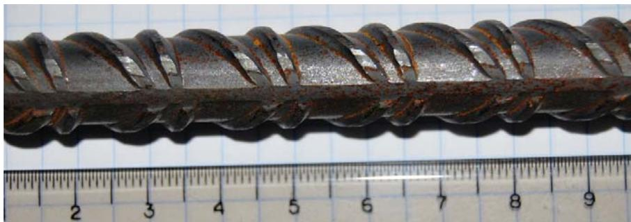
Fig. 3.33. Geometría superficial de las barras de acero corrugadas A12.
