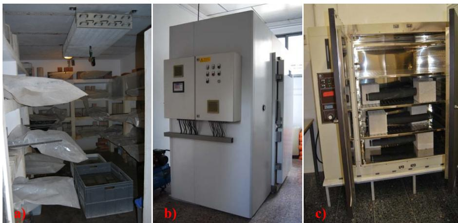
**Fig. 3.50.** a) Cámara de curado; b) Cámara climática de condición 5, 20 y 40 °C; c) Cámara climática de condición 80 °C.
