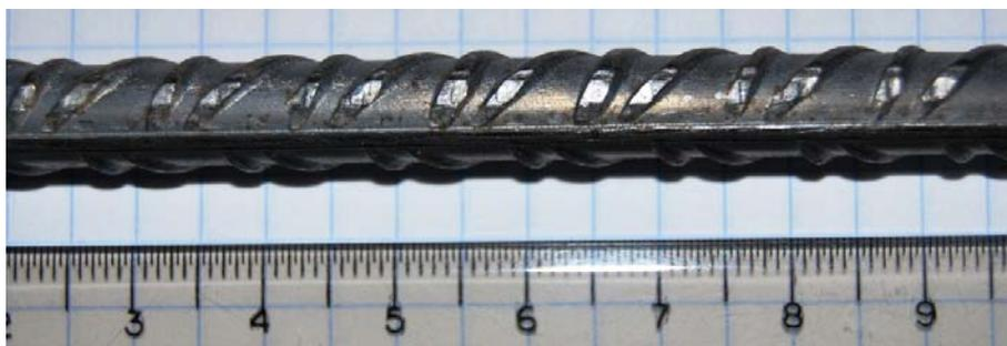
**Fig. 3.32.** Geometría superficial de las barras de acero corrugadas A8.
