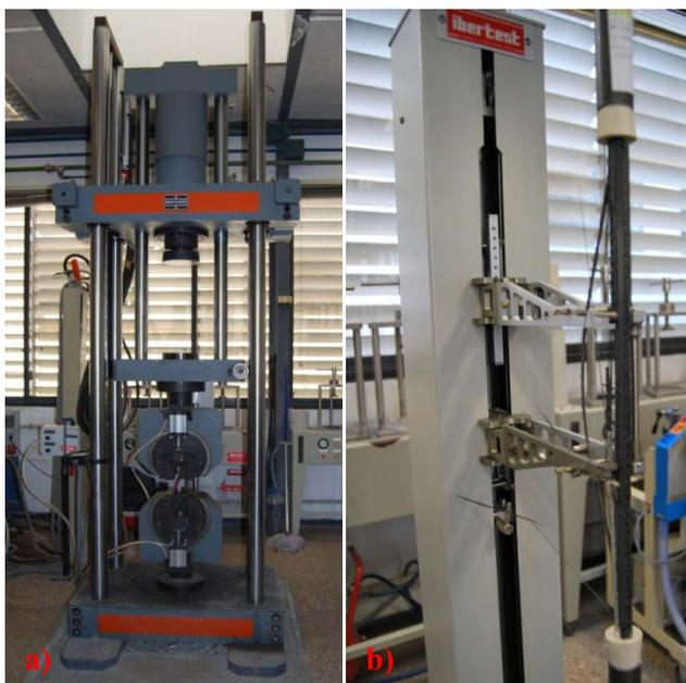
**Fig. 3.35.** a) Máquina de ensayo a tracción; b) Captador de deformaciones.
