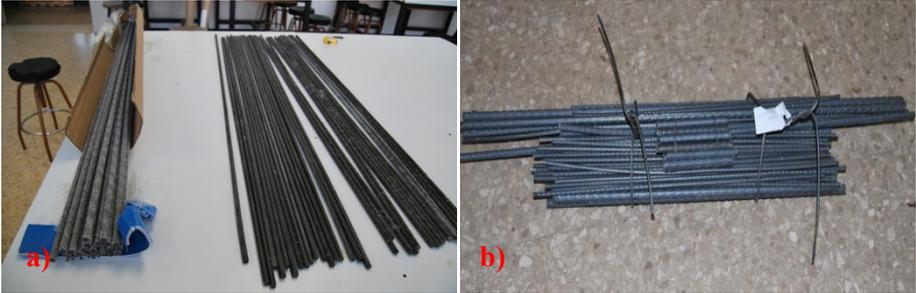
Fig. 3.38. Barras a ensayar: a) CFRP; b) Acero
