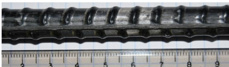
Fig. 3.2. Barra de CFRP Corrugada.
