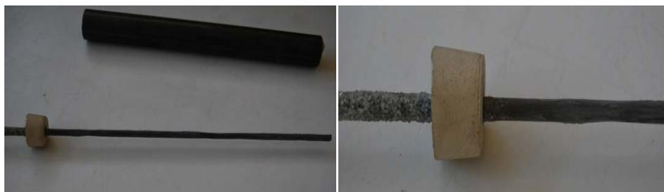
**Fig. 3.15.** Longitud de anclaje sin geometría superficial en barras de CFRP arenadas.
