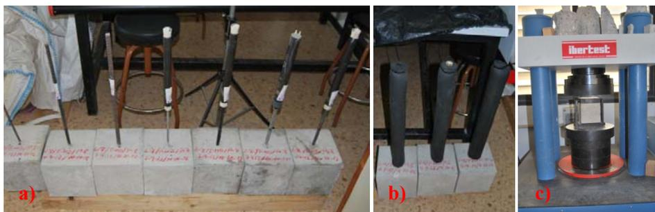
**Fig. 3.56.** a) Fabricación de anclajes; b) Colocación de aislante térmico en probetas de pullout; c) Ensayo de compresión en probetas de control del hormigón.
