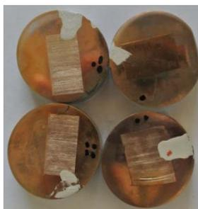
**Fig. 3.80.** Muestras de CFRP para ensayo de SEM
