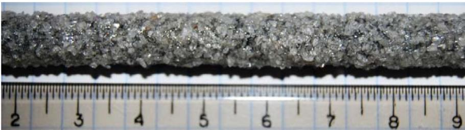
Fig. 3.28. Geometría superficial de las barras de CFRP arenadas CA8.
