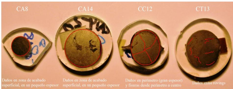
Fig. 4.18. Daños y fisuras en las barras de CFRP tras el ensayo de pullout.
