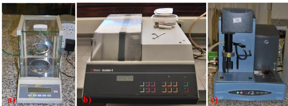
Fig. 3.63. Máquinas ensayo TGA: a) Báscula de precisión; b) Cortadora; c) Máquina de TGA.
