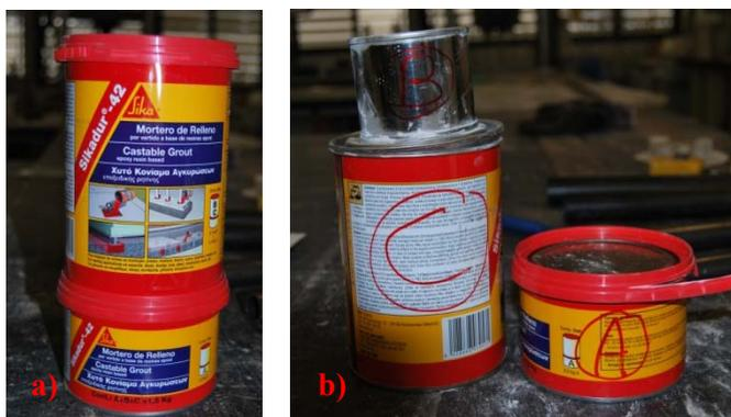
Fig. 3.13. Resina de epoxi Sikadur 42: a) formato 1,5 kg; b) Componentes Sikadur 42
