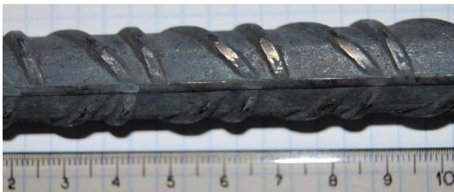
Fig. 3.34. Geometría superficial de las barras de acero corrugadas A16.
