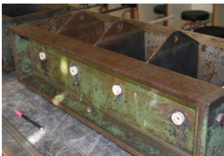
Fig. 3.47 Molde de fabricación de probetas de pullout.
