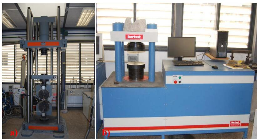
Fig. 3.52. Máquinas de ensayo: a) Prensa pullout; b) Prensa compresión.
