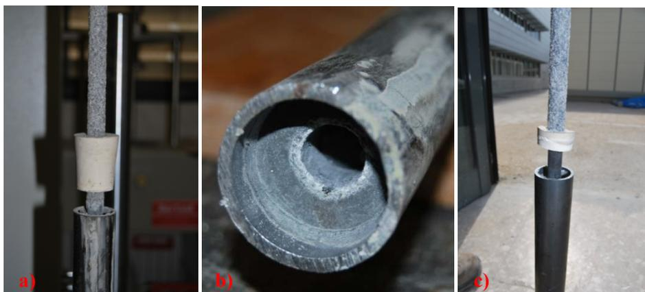
**Fig. 3.16.** Deslizamiento en anclajes en ensayo de tracción de barras CA14: a) Deslizamiento extremo inferior con MA; b) Rotura adhesión geometría/núcleo con MA; c) Deslizamiento extremo inferior con RE.
