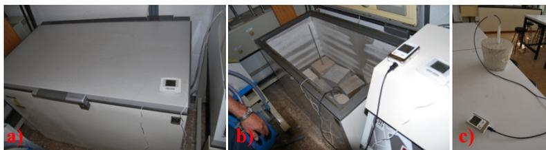
Fig. 3.5. a) arcón; b) ciclo de hielo; c) probeta de hormigón con sonda.
