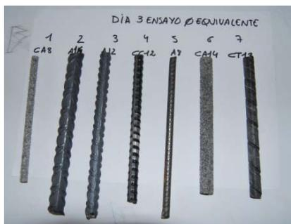
Fig. 3.23. Muestras para ensayo de Diámetro Equivalente.
