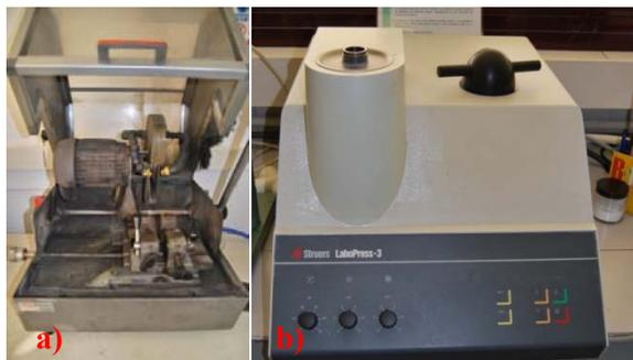
**Fig. 3.70.** Equipos de ensayo: a) Cortadora; b) Embutidora; c) Microscopio Óptico
