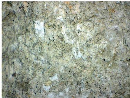
**Fig. 4.5.** Superficie de la longitud adherente de hormigón tras el ensayo de EPU/L11/T20/P7/CA14
