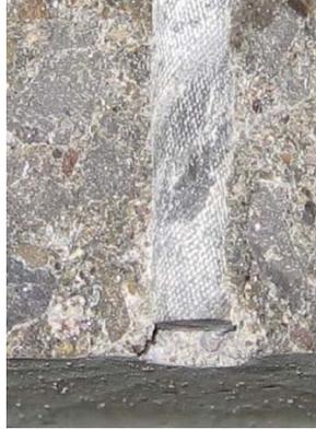
**Fig. 2.60.** Restos de hormigón en la superficie de la barra de CFRP texturizada tras el ensayo de pullout. Davalos et al., 2008.
