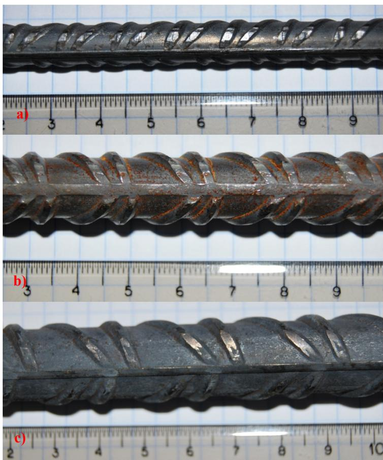
Fig. 3.4. Barra de Acero Corrugada: a)  $\varnothing$  8 mm.; b)  $\varnothing$  12 mm. ; c)  $\varnothing$  16 mm.
