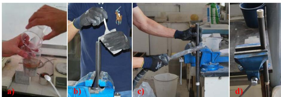
**Fig. 3.40.** Proceso de fabricación de los anclajes de las barras de CFRP.
