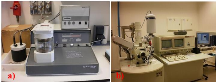
**Fig. 3.79.** a) Recubridor de muestras; b) Microscopio electrónico de barrido.
