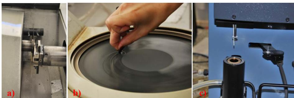
**Fig. 3.64.** Proceso de ensayo de TGA: a) Cortado de muestras; b) Modelado de muestras; c) Ensayo en máquina de TGA.
