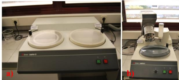
**Fig. 3.78.** Maquinas pulidoras de muestras a) Labopol-5; b) Labopol-21
