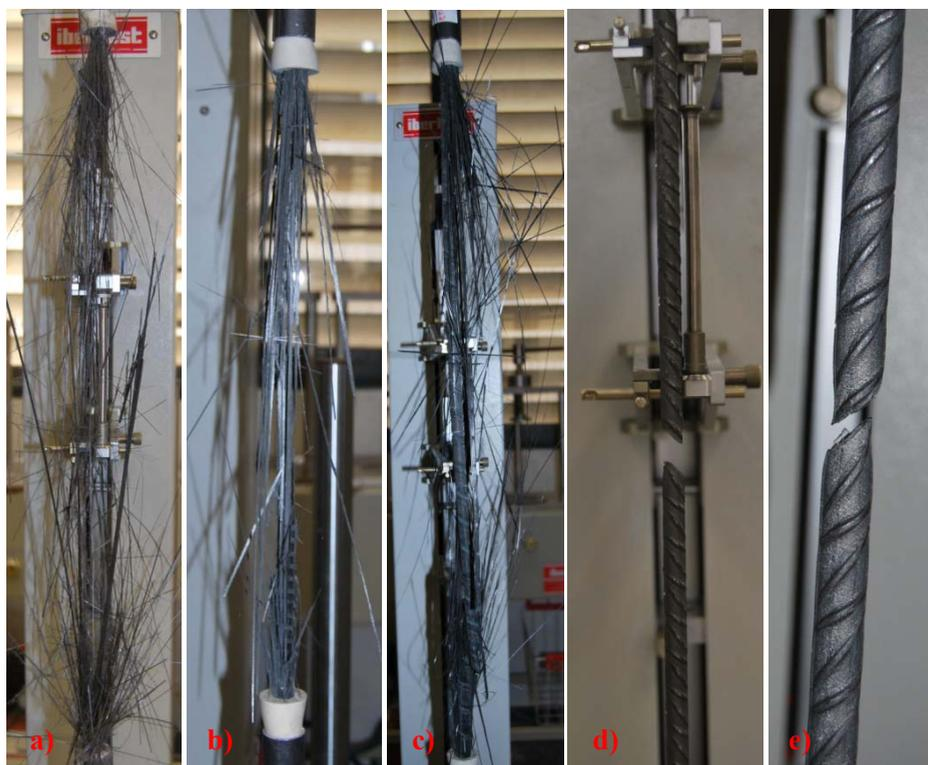
**Fig. 3.41.** Modo de rotura: a) Splitting CA8; b) Splitting CC12; c) Splitting CT13; d) Agotamiento, A8; e) Agotamiento A12
