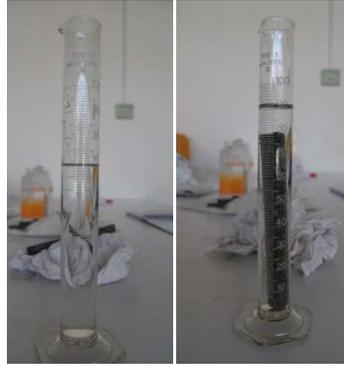
Fig. 3.24. Medición del volumen: a)  $V_0$ ; b)  $V_1$ .
