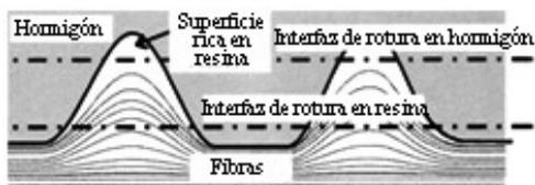
**Fig. 2.54.** Parámetros que intervienen en la rotura por adherencia de las barras de CFRP corrugadas. Achillides et al., 2004.
