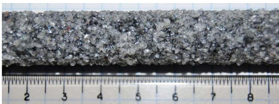
**Fig. 3.29.** Geometría superficial de las barras de CFRP arenadas CA14.
