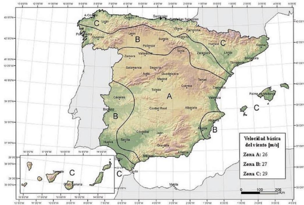
Figura 4.11 Mapa de isotacas para la obtención de la velocidad básica fundamental del viento.
