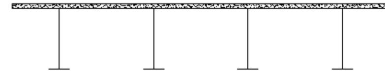
Figura 3.1 – Sección transversal de simple acción mixta.
