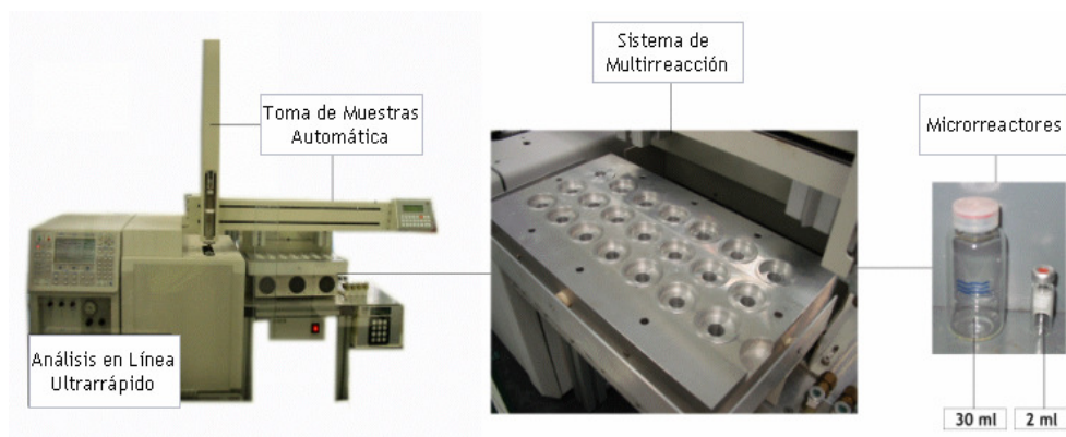
Figura 5.3.5. Sistema de multirreacción utilizado en los test de catalizadores para epoxidación de olefinas. 21 reacciones pueden ser estudiadas simultáneamente en viales de 2mL.
