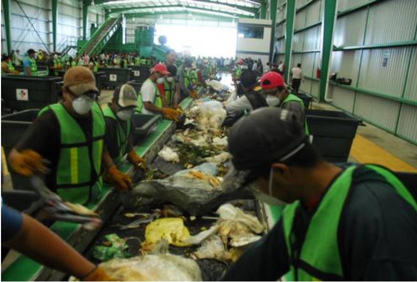
Figura 3.11.- Separación manual de residuos
