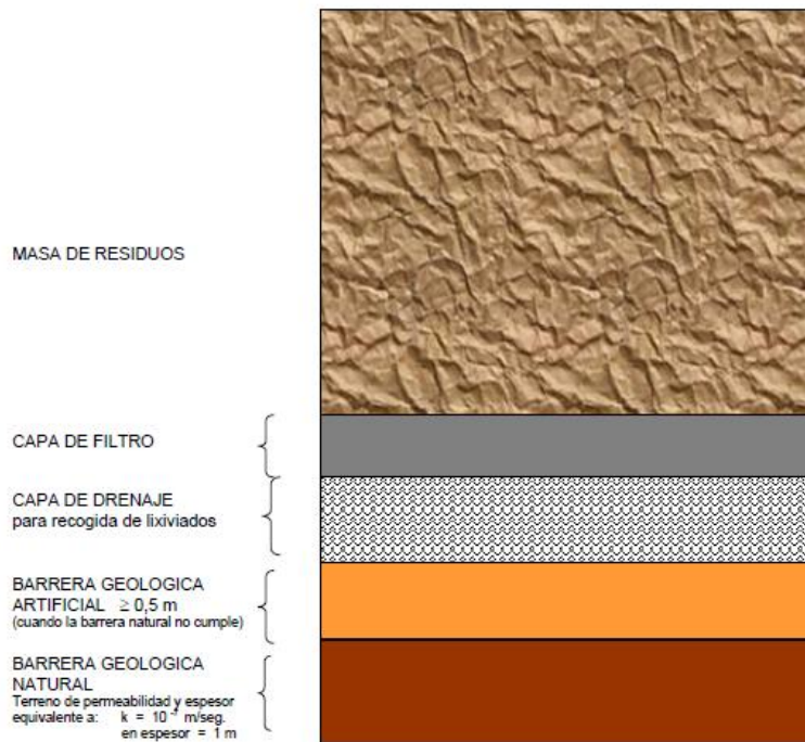
Figura 9.4.- Impermeabilización en vertederos de residuos inertes
