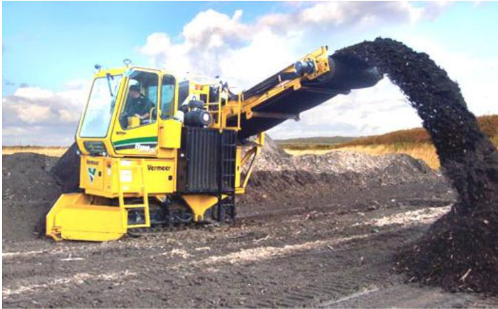
Figura 6.5- Volteadora trabajando en campo
