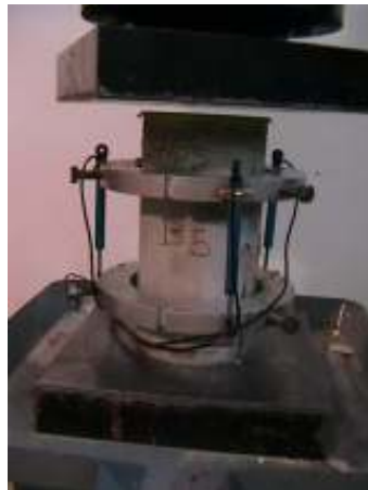
Ilustración 53. Fotografías de los captadores extensométricos utilizados para medir el módulo de elasticidad en hormigones
