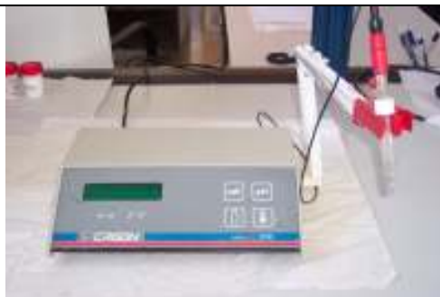
Ilustración 25 Fotografía del pH-metro de sensibilidad 0,01 unidades de pH
