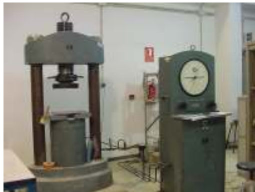
Ilustración 52. Fotografía de prensa para medir la resistencia a compresión de los hormigones
