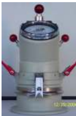
Ilustración 35. Fotografía de Aerómetro para el ensayo de aire ocluido en morteros
