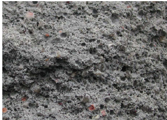
Ilustración 13. Apariencia microscópica del mortero con adición del 0,2 % de aditivo proteínico 18
