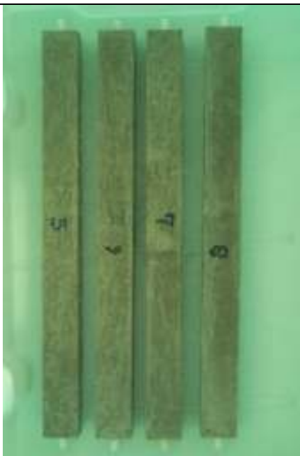
Ilustración 136. Fotografía de probetas sometidas a un ataque por sulfato de sodio
