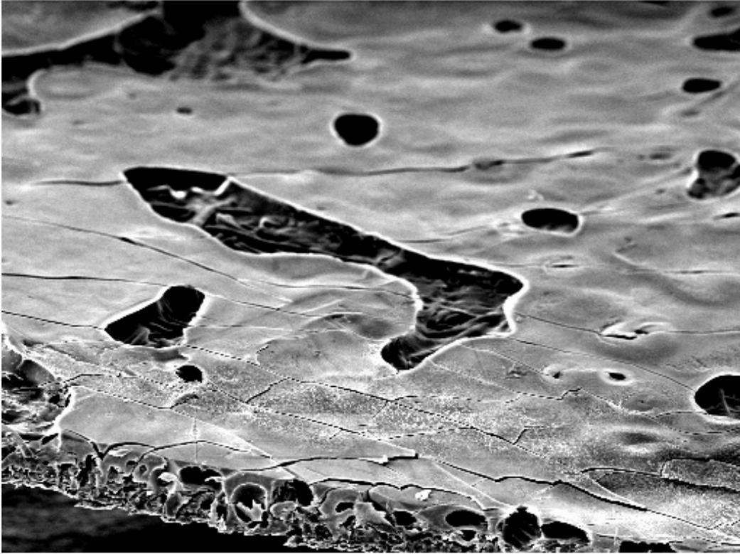
***Ilustración 100. Muestra 6 - 75X. Despegue de la capa de acetato de celulosa en el soporte FO-2401***
