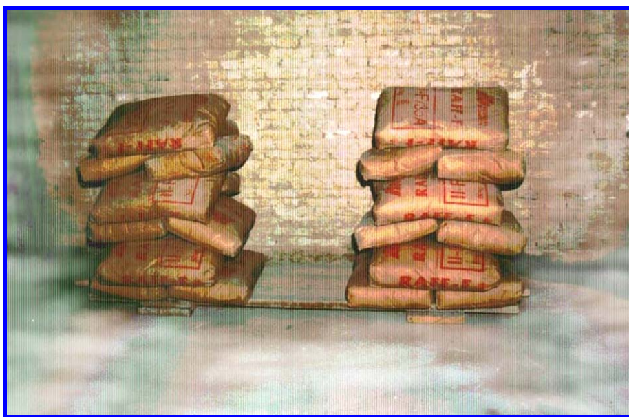
Fig. 4.40 Vigueta reforzada en el escalón de carga de 600 Kp. , forjado nº4
