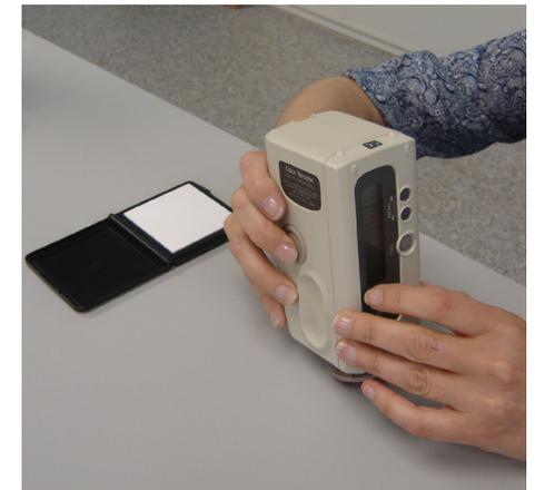
Fig.161. Medición colorimétrica de muestras, mayo 2014
