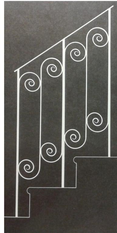
Fig.129. Patron de barandillas de hierro forjado. Fuente: *idem*
