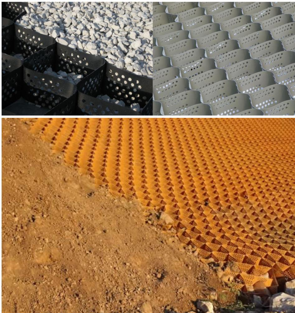
Los paneles se colocan unos al lado de los otros, desde la parte superior del talud hasta su base, anclándolos con elementos de acero de longitud variable. La densidad de los elementos de anclaje de CETCOCELL es de 1,5 ud/m<sup>2</sup>, colocados en todo su perímetro y en el centro del panel. Los anclajes deben tener como mínimo 0,50 m. de longitud y 12 mm. de diámetro. Se utilizarían geoceldas perforadas para la perfecta evacuación de agua.
