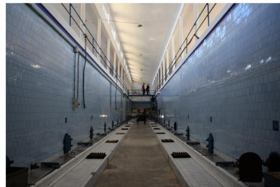
En la primera de ellas se observa el pasillo central del que se hablaba anteriormente generado por el escalonamiento de los depósitos, dejando así que se trabaje por gravedad.
