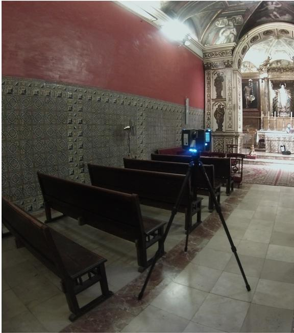
Figura 7. Escáner laser Faro Scan 130
