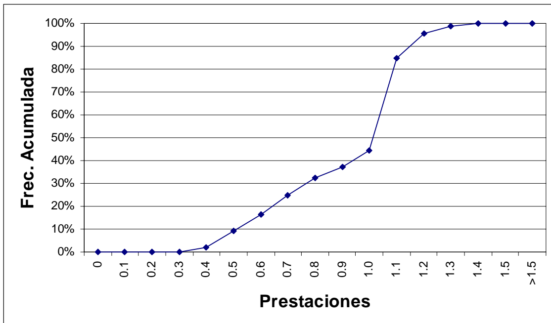
Figura 20. Histograma de frecuencias acumuladas para U_o/U_i . El eje Y indica el porcentaje de sistemas con un valor menor o igual que el valor indicado por el eje X. Prioridades fijas.
