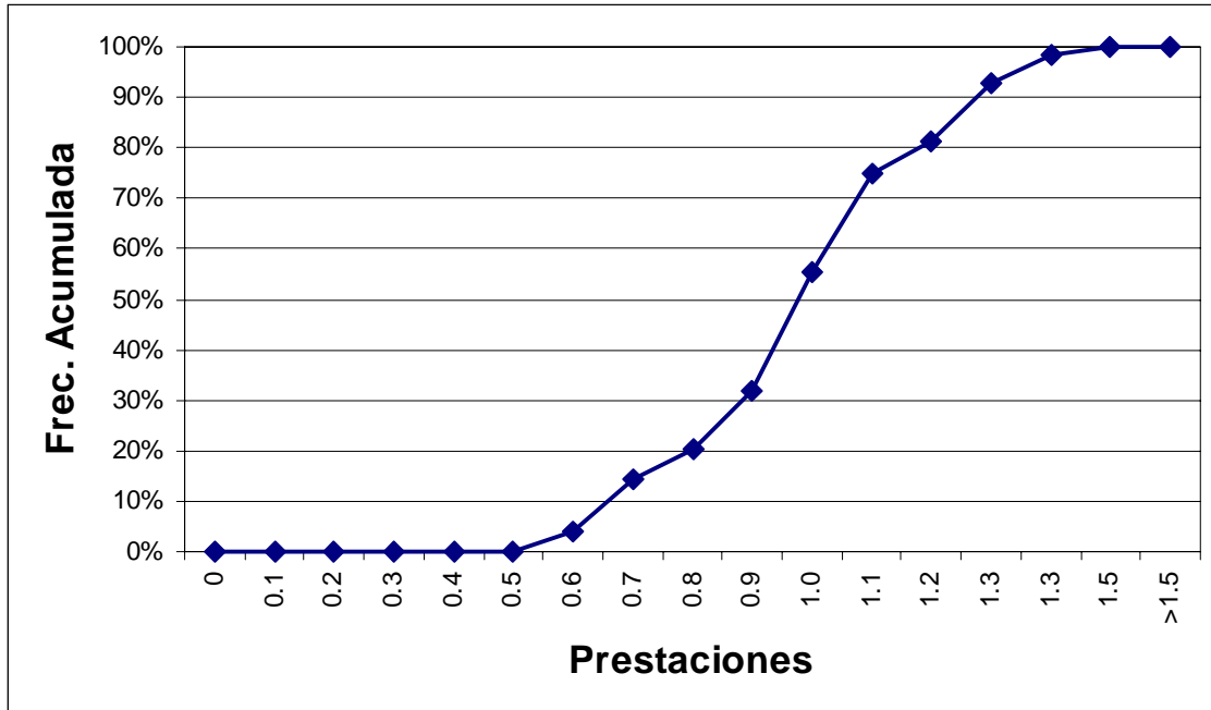
Figura 33. Histograma de frecuencias acumuladas para U_o/U_i . El eje Y indica el porcentaje de sistemas con un valor menor o igual que el valor indicado por el eje X. Uso dinámico.
