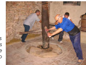
Prensa de vino. Las cuatro vigarras (brazos) son las encargadas de mover el husillo (punto central).
