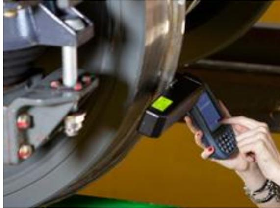
Figura 2. 7 Sistema CMMI para revisión de ruedas ferroviarias.
