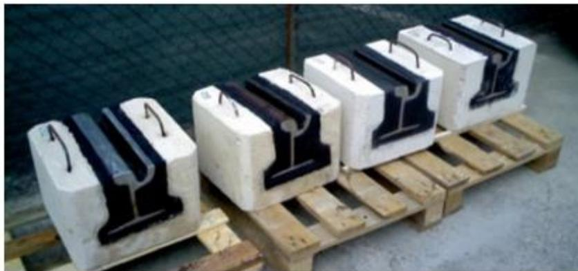
*Figura 2. 31. Carril embebido en resina con polvo de caucho. Fuente: Acciona Infraestructuras.*
