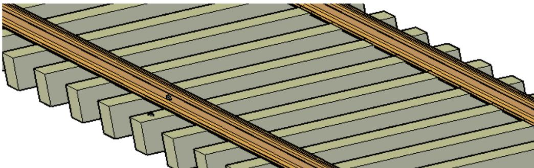
Figura 5. 16 Detalle de la ubicación de los acelerómetros en el punto de control de la vía. Fuente: Elaboración propia.
