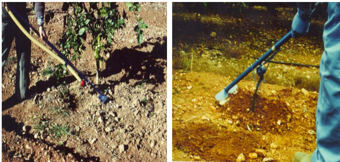
Fig. 4.- Maquinaria manual para la aplicación comercial de aldicarb. Se utiliza, generalmente, para aplicaciones en riego localizado y plantones.
