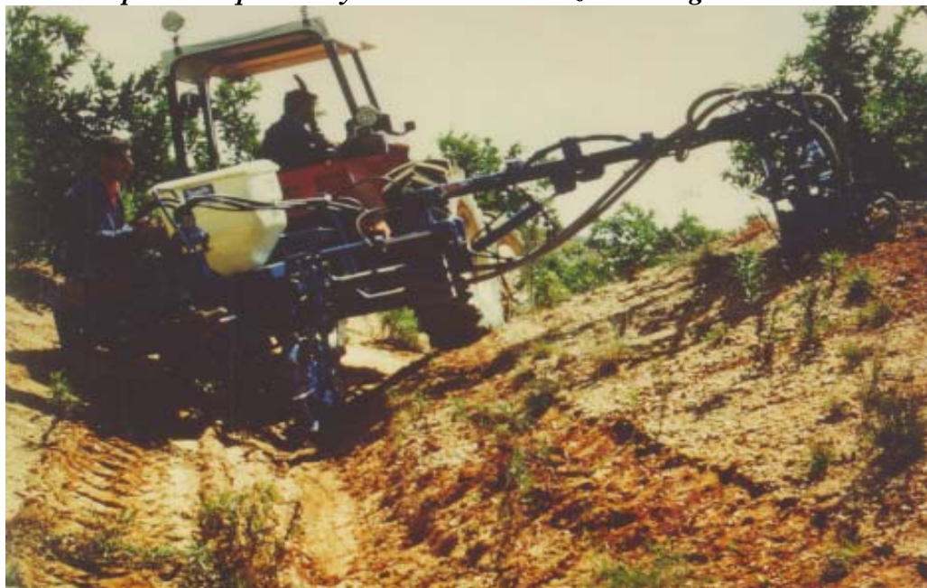
Fig. 7.- Distribuidora de microgránulos neumática accionada por tractor de elevada potencia. Es utilizada en grandes explotaciones citrícolas.
