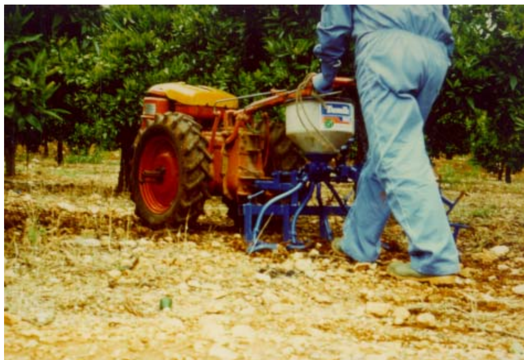
Fig. 6.- Maquinaria para aplicación continua de aldicarb mediante motocultor. Obsérvense las cuatro rejas que
