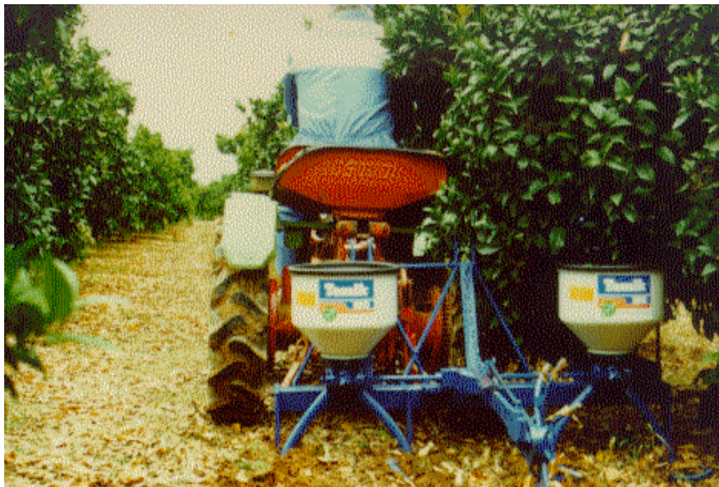
Fig. 5.- Maquinaria para la aplicación continua de aldicarb mediante tractor ligero. Obsérvense las cuatro rejas que practican un surco, incorporando el producto y cubriéndolo con suelo.
