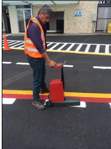
Ilustración 55 Retrorreflectómetro de 30 metros
