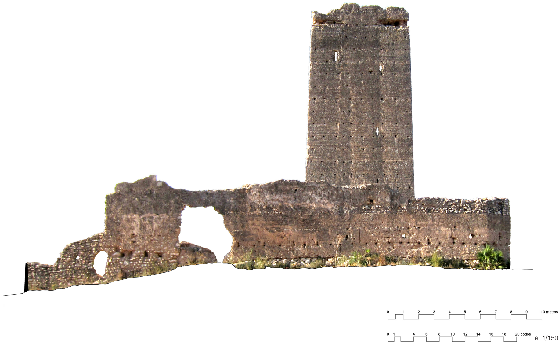
Fig. 5.7. Alzado Norte. Levantamiento ortofotogramétrico. (Elaboración propia)
