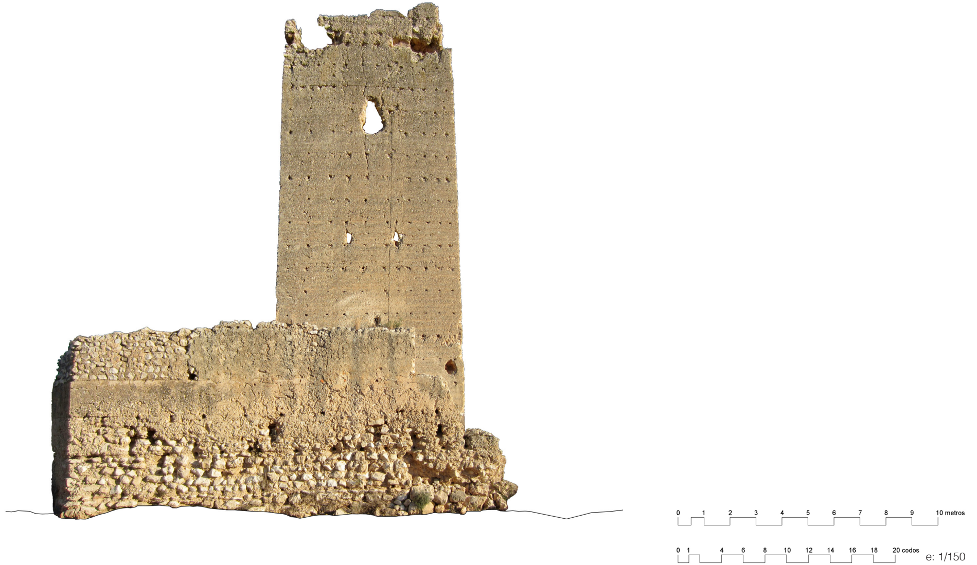
Fig. 5.5. Alzado Oeste. Levantamiento ortofotogramétrico. (Elaboración propia)
