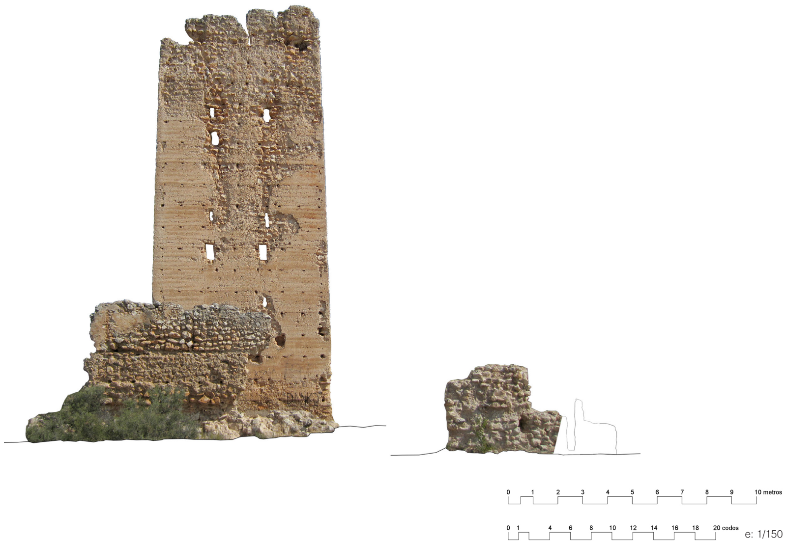
Fig. 5.3. Alzado Sur. Levantamiento ortofotogramétrico. (Elaboración propia)
