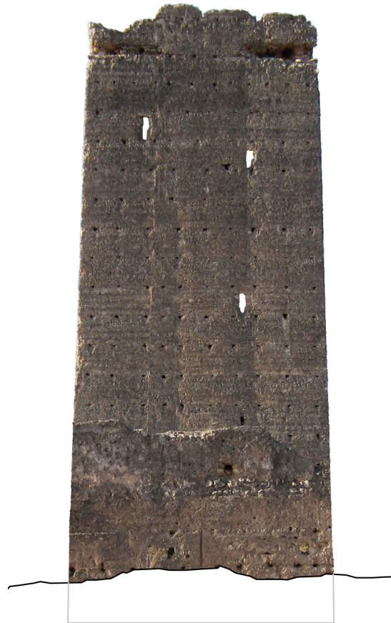
Fig. 6.21. Levantamiento ortofotogramétrico del alzado Norte. (Elaboración propia) e: 1/150
