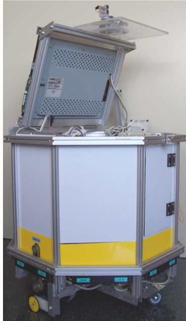
Figura 1.1: El prototipo de robot móvil de tracción diferencial conocido como YAIR(*Yet Another Intelligent Robot*)
