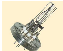
Fig. 2.6. Izquierda: esquema de un sensor tipo Bayard–Alpert. Derecha: fotografía de dichos elementos. (Serra, 2009).
