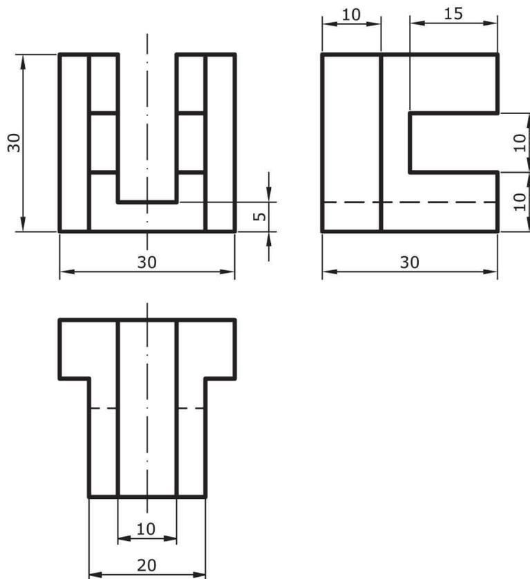
4.- Dibujar a escala 3:2 el alzado, la planta y la vista lateral derecha del objeto dado por su perspectiva, en el sistema de vistas del primer diedro (antiguo europeo). El alzado es el que se indica. Tomar las medidas directamente de la figura. Realizar la acotación completa de las mismas según la norma UNE.
