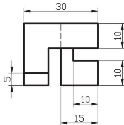
5.- Dibujar a escala 3:2 el alzado, la planta y la vista lateral derecha del objeto dado por su representación isométrica a escala 1:1 y sin coeficientes de reducción. El alzado es el que se indica. Tomar las medidas directamente de la figura. Realizar la acotación completa de las mismas según la norma UNE. Dibujar la escala gráfica.
