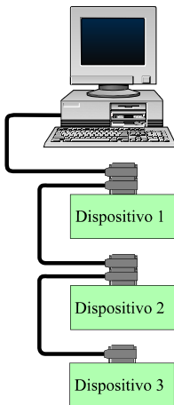
Figura 2. Ejemplo de conexión del bus GPIB en línea.
