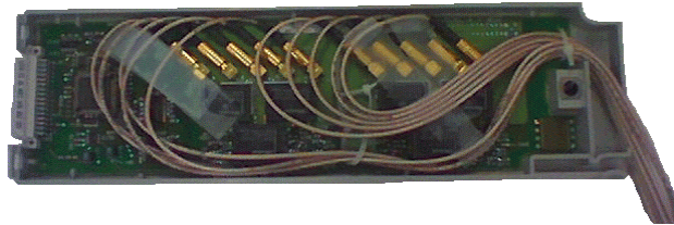
Figura 61. Tarjeta con dos sistemas multiplexores de 1 a 4. Utiliza el relé de la figura 60.
