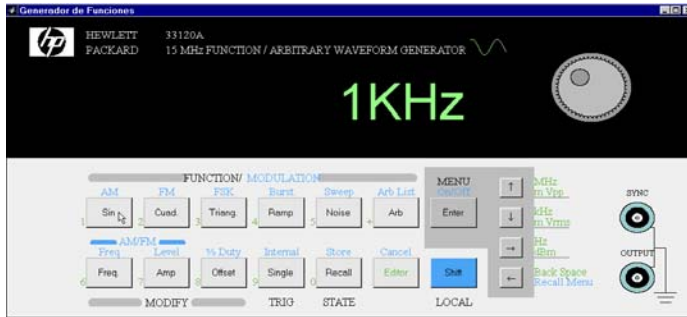
Figura 13. Ejemplo de panel frontal de instrumento realizado con el lenguaje Matlab. Por cortesía de [13].
