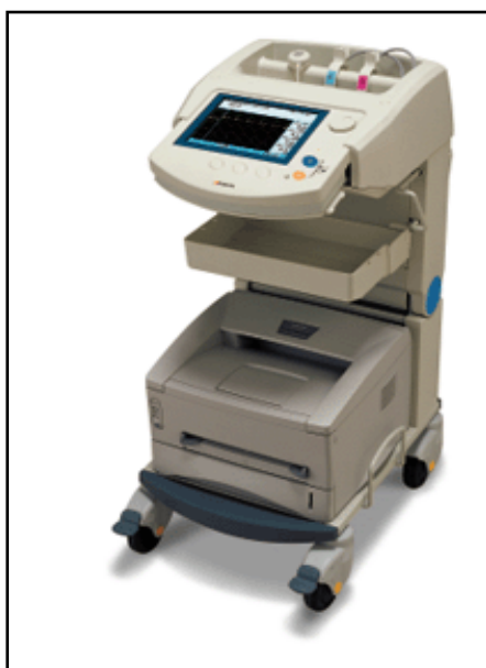
Figura 3.15 Equipo VP-1000 (Colin Co. Komaki, Japan) el cual está compuesto por el módulo de medición en la parte superior y el módulo de impresión en la parte inferior. (Tomado de Colin Co.).
