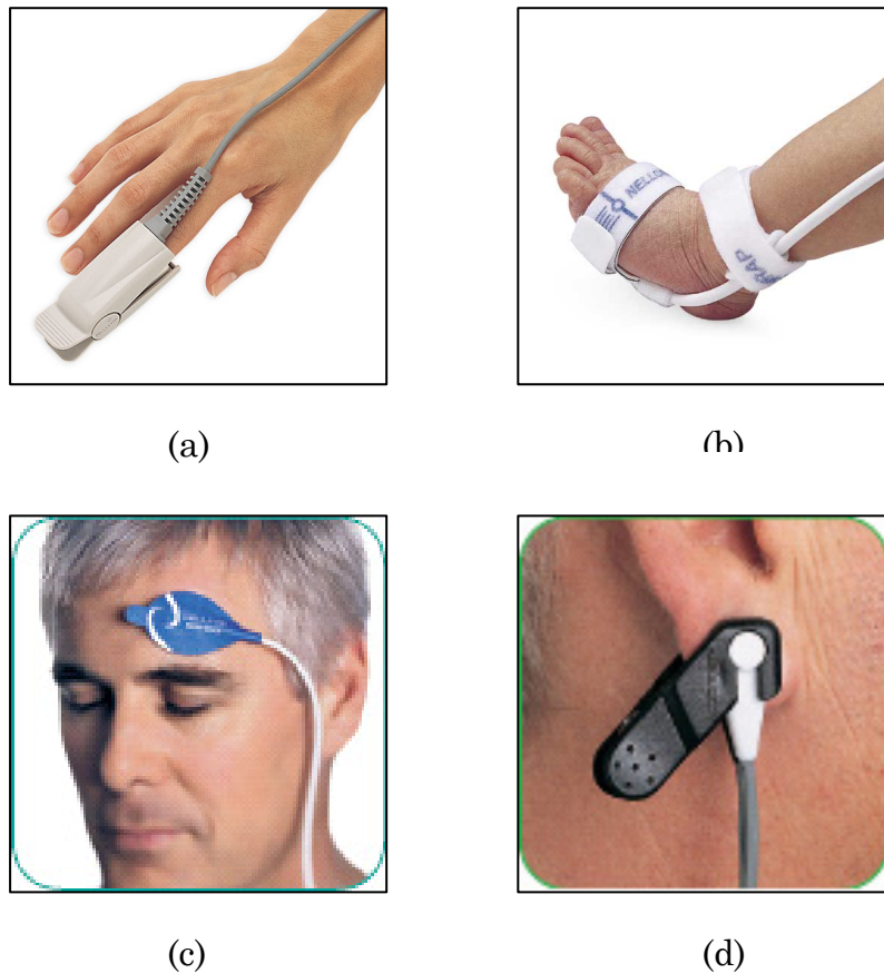
Figura 3.32 Sensores ópticos para fotopleletismografía. a) Sensor para PPG para uso en dedos de las manos. b) Sensor para PPG de uso pediátrico. e) Sensor PPG para uso facial. d) Sensor de PPG para uso en el lóbulo del oído. (Tomado de Nelcor).
