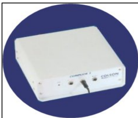
Figura 3.25 Equipos Complior Artech Medical a) Equipo Artech Medical modelo Complior II para tres sensores de registro, b) Equipo Artech Medical modelo Complior SP para cuatro sensores de registro. (Tomado de Artech Medical).
