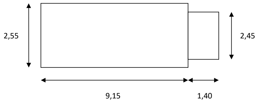
Imagen 44: dimensiones de vehículo tipo
