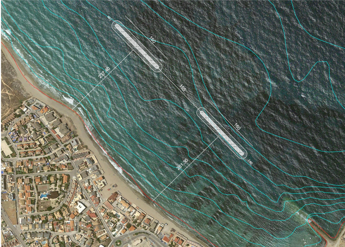
4. Diseño en planta de los diques
