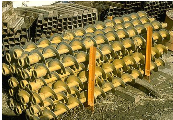
FIGURA A.48. VARILLAS EMPLEADAS EN LA TÉCNICA INSERCIÓN DE TUBERÍA MEDIANTE EL TALADRO CON TORNILLO SIN FIN.
