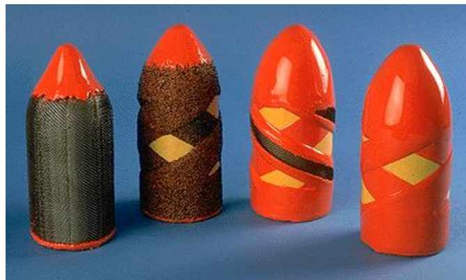
FIGURA A.17. DIFERENTES TIPOS DE BALAS ABRASIVAS.
