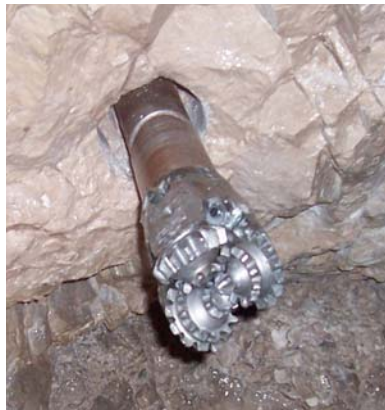
FIGURA A.41. CABEZAL UTILIZADOS PARA LA EXCAVACIÓN EN ROCA.
