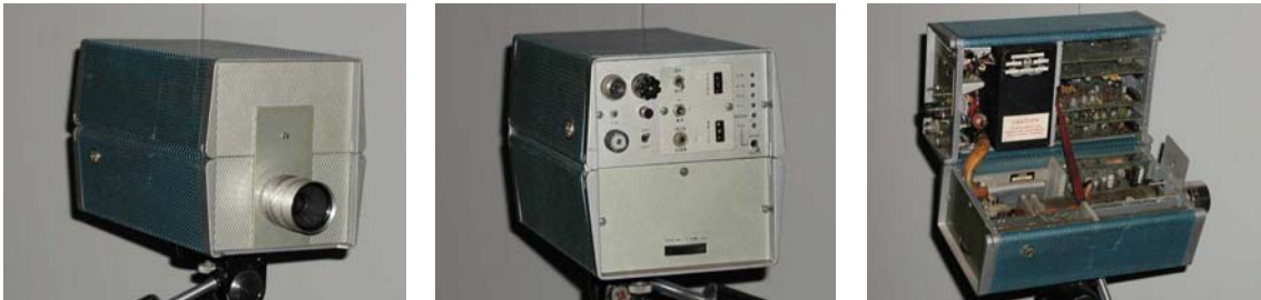
FIGURA A.7. CÁMARAS CON TUBO DE VIDICON DE LOS AÑOS 50 FABRICADAS POR RCA CORPORATION .
