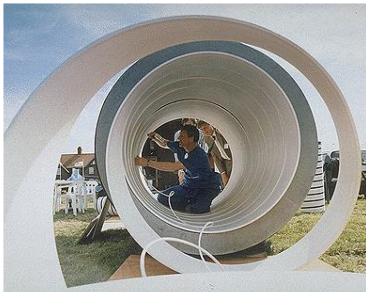
FIGURA A.30. LAMINA DE PVC CORTADA HELICOIDALMENTE.
