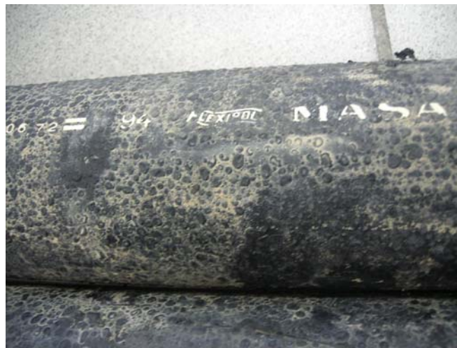
FIGURA 32. DECAPADO EXTERIOR EN UNA TUBERÍA DE LDPE (CORTESÍA DE AGUAS DE VALENCIA).
