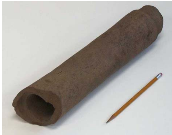
FIGURA 11. TUBERÍA DE ARCILLA UTILIZADA EN EL AÑO 1800 EN CALIFORNIA (WWW.SEWERHISTORY.ORG).
