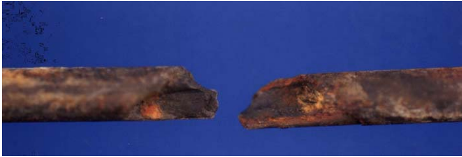
FIGURA 25. ROTURA FRÁGIL DE LOS ALAMBRES DE ACERO POR EXPOSICIÓN AL HIDRÓGENO.
