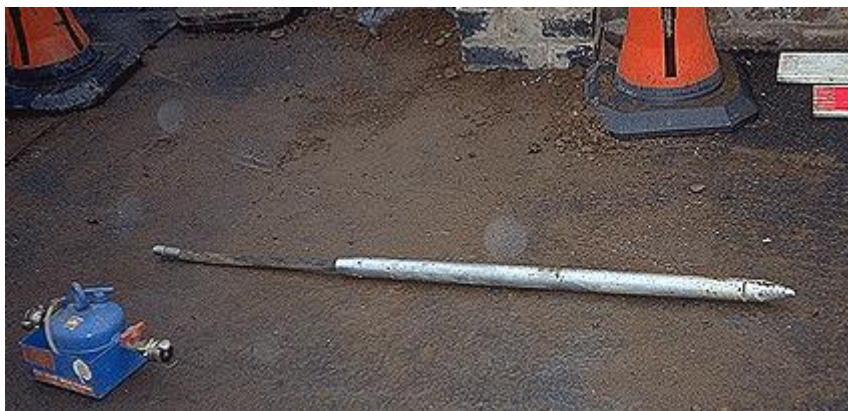
FIGURA A.43. CILINDRO METÁLICO QUE SE INSERTA EN EL TERRENO.
