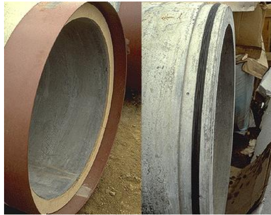
FIGURA A.51. TUBERÍAS MACHO Y HEMBRA UTILIZADAS EN LAS HINCAS.
