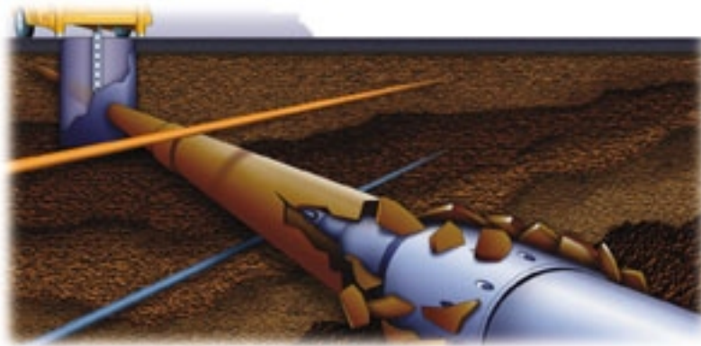
FIGURA A.35. INSERCIÓN DE NUEVA TUBERÍA CON ROTURA DE LA ANTIGUA CONDUCCIÓN CON MOTOR ACCIONADO HIDRÁULICAMENTE.
