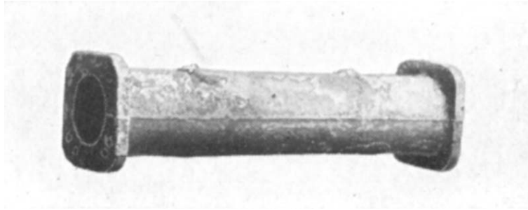
FIGURA 14. TUBERÍA DE FUNDICIÓN GRIS QUE SIRVE PARA TRAER AGUA HASTA LOS JARDINES DE VERSALLES. TODAVÍA EN SERVICIO EN EL AÑO 1914 (WWW.SEWERHISTORY.ORG).
