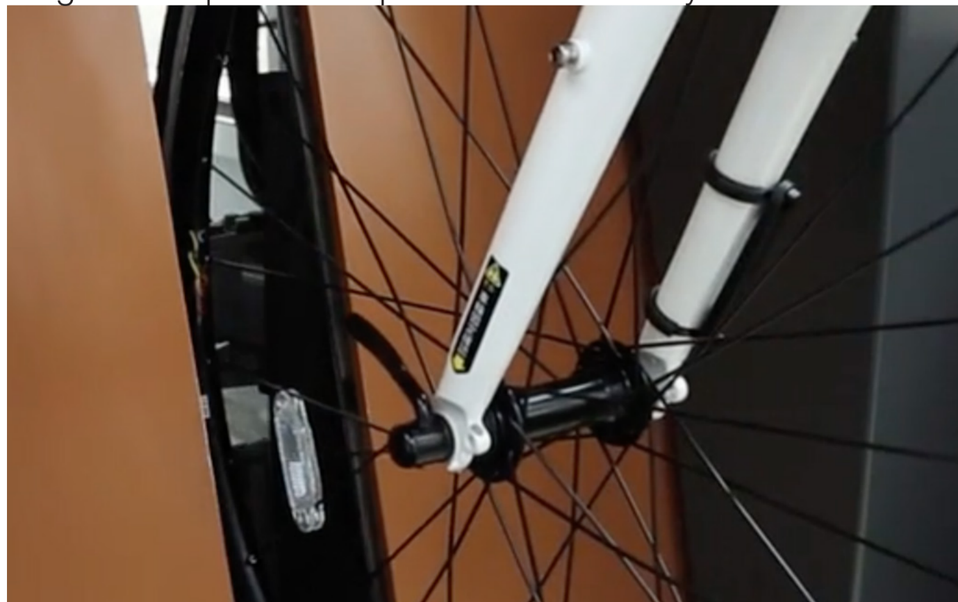
Fig. 60. Colocación de la rueda en ECO Cycle
