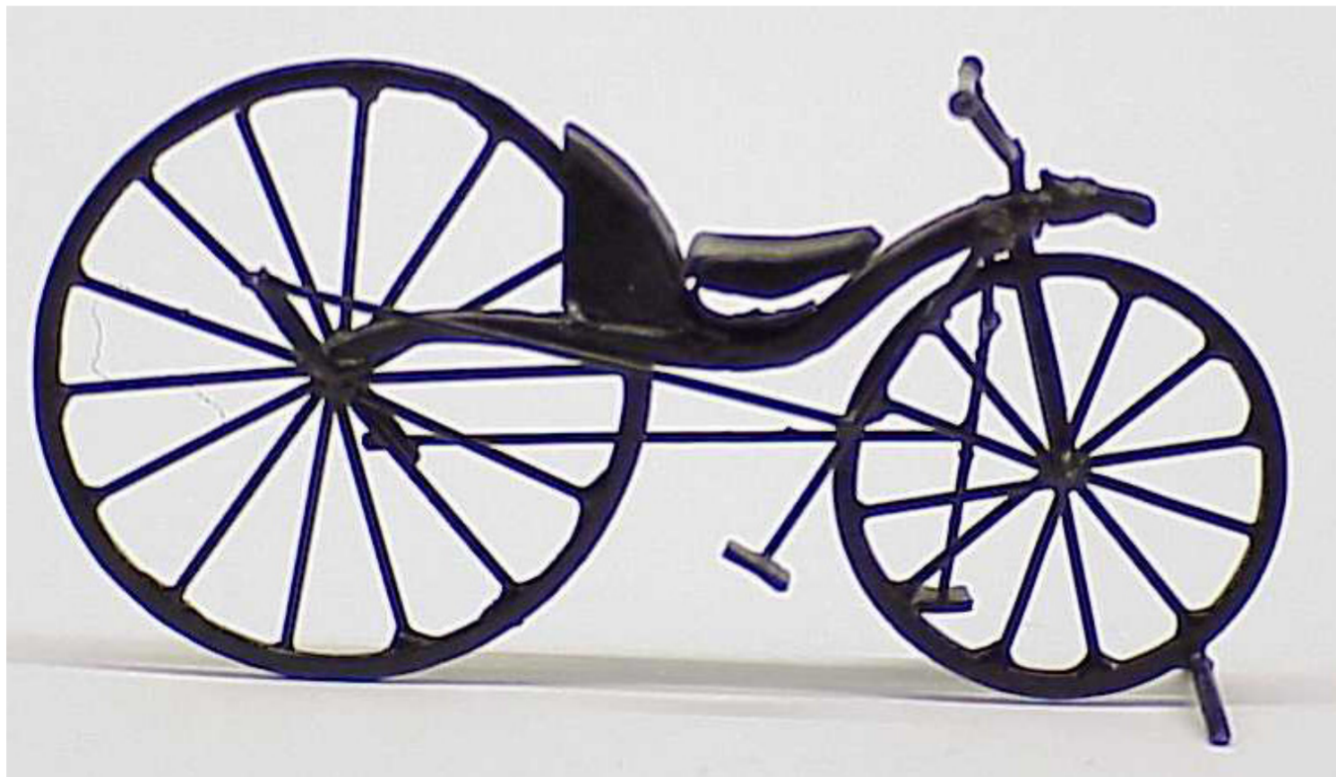
Fig.2. El velocípedo de Macmillan (1839), funcionaba con pedales con el mismo movimiento de los trenes. Aún no existía correa de transmisión.
