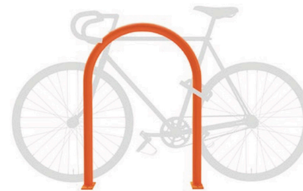
Fig.19. Esquema de cómo ha de quedar fijada la bicicleta en soporte U-invertida.
