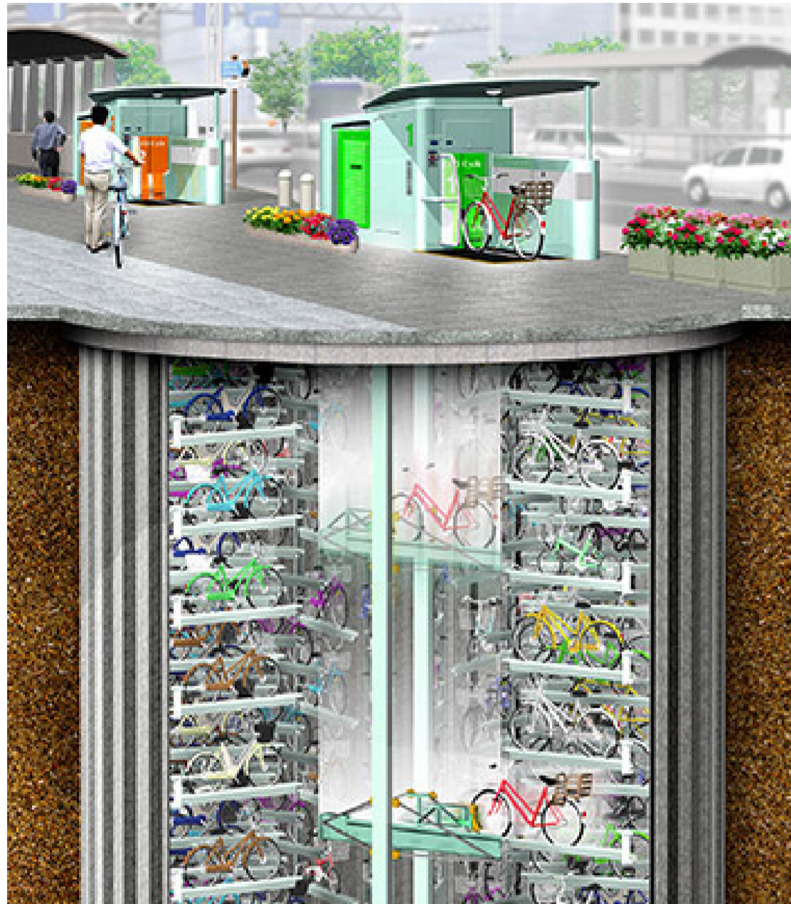
Fig. 59. Esquema del aparcamiento ECO Cycle.
