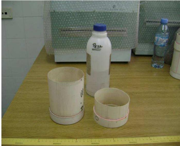
Figuras 3.7. Método de determinación de densidad aparente de los sustratos empleados en el ensayo
