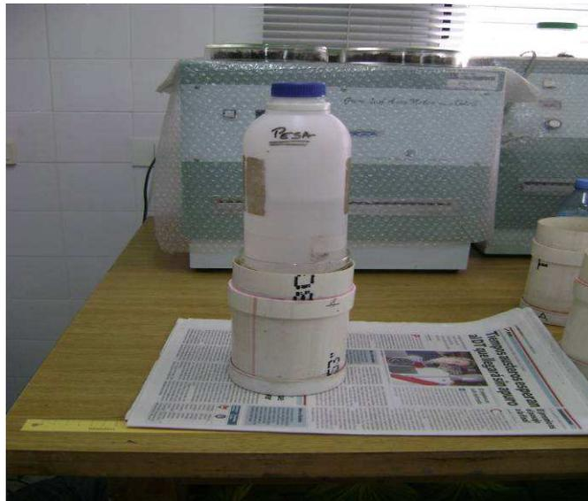
Figura 3.8. Método de determinación de densidad aparente de los sustratos empleados en el ensayo
