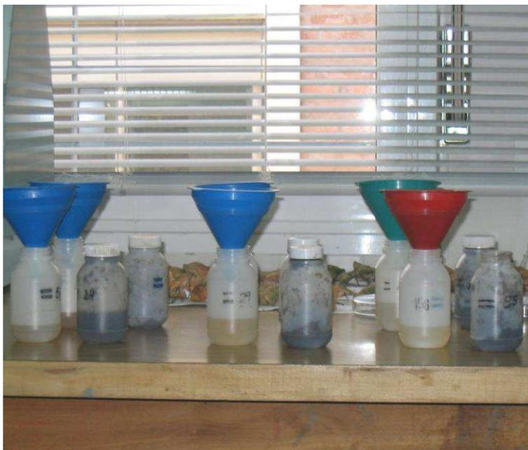
Figura 3.6. Extracción de solución 1/5 (v/v) para la determinación de pH, CE y nutrientes
