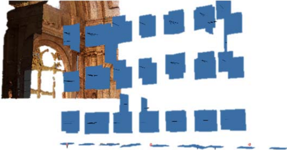
Figura 10: Resultado visual de la orientación de las imágenes y del escáner láser terrestre. Los puntos de color rosado, es la posición de los escaneos
